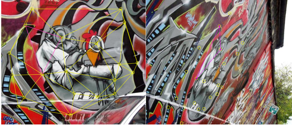
Imagen 11. Triangulación "keypoints" a través de Delaunay a la derecha y proyección del triángulo en magenta en imagen proyectiva.
