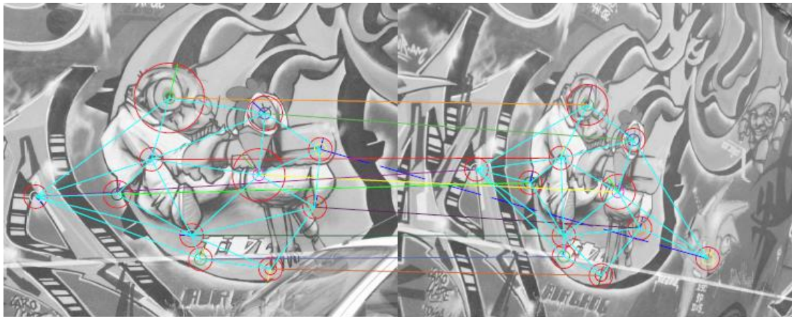
Imagen 12. Emparejamiento de características de “keypoints”, triangulación Delaunay en la imagen de la izquierda y correlación de triangulación en la imagen de la derecha por emparejamiento de puntos clave.
