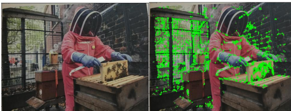
Imagen 2: Detección de puntos clave mediante FAST.
