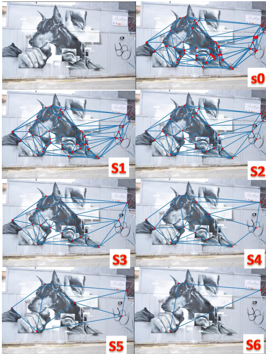
Imagen 21. Diferentes escalas del grafo piramidal desde la escala s0 hasta la escala s6.
