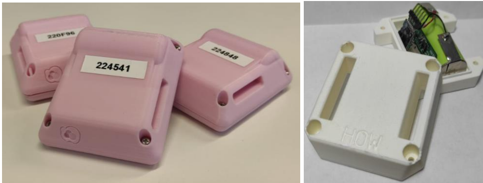
Figura 23: Imagen de las carcacas para los collares iniciales (rosa) y carcacas para el collar final (blanco).
