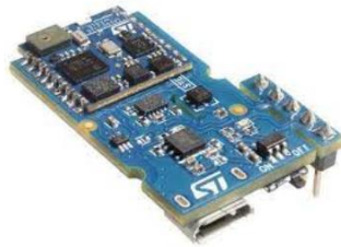
Figura 10: Placa STEVAL-STLCS01V1 con los escudos STLCX01V1 y STLCR01V1.
