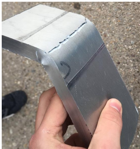
Ilustración 68: Resultado de ensayos de plegado de aluminio 6082 T651
