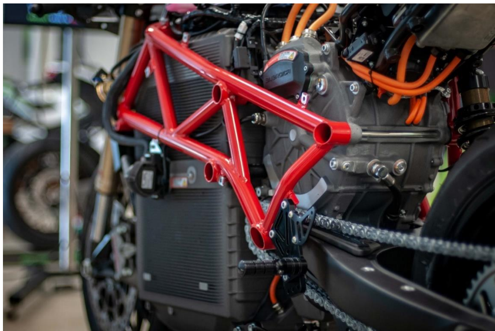
Ilustración 19: Detalles de los anclajes de la Energica Ego Corsa (Beeler, Under the Hood of the Energica Ego, 2019)
