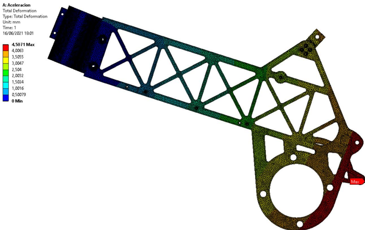
Ilustración 93: Desplazamiento total en aceleración máxima
