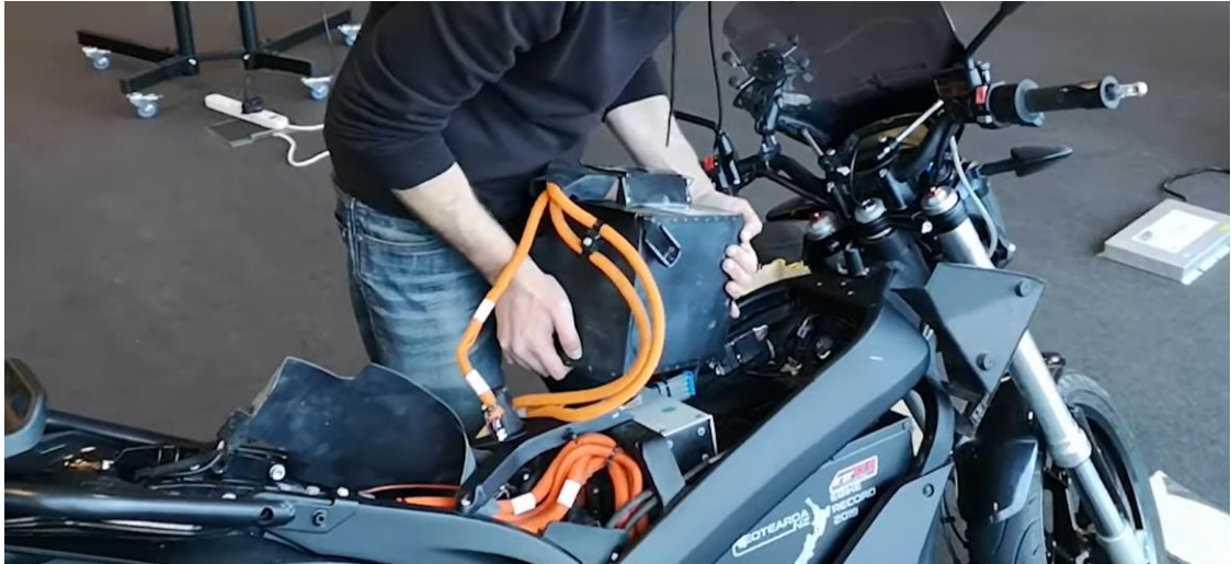
Ilustración 23: Montaje de la batería de la Zero S (NewZeroland, 2019)
