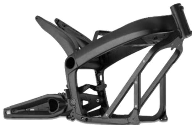
Ilustración 22: Chasis, basculante y subchasis de la Zero S (MediaWiki, 2020)
