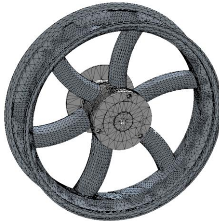
Ilustración 60: Mallado en llanta trasera
