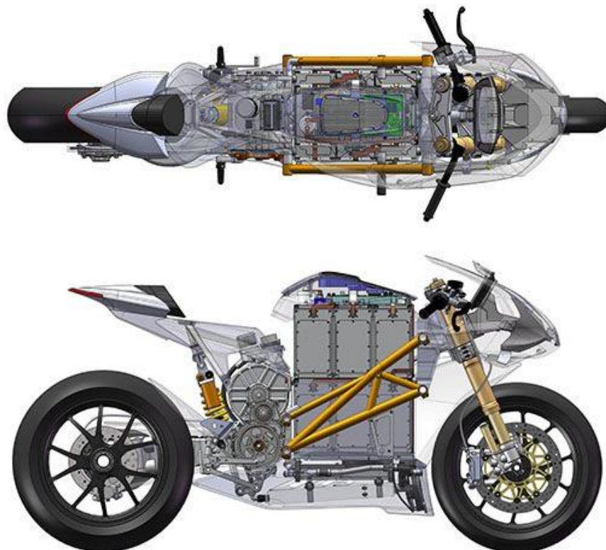
Ilustración 26: Planta y perfil de la Mission R (Cathcart & Wing, 2012)
