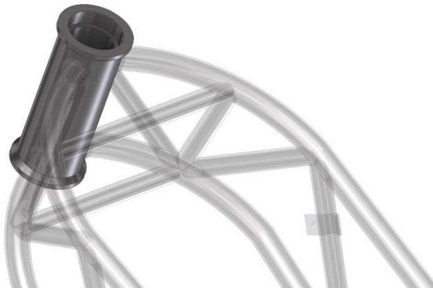
Ilustración 66: Pipa de dirección de EUPLA Racing Team en la edición V
