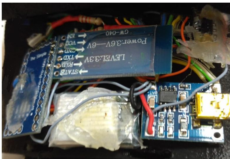
Figura B.5 Conexiones soldadas del sistema completo
