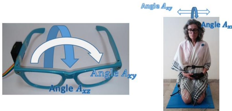
Figura 3.5 Dirección de los ángulos de rotación con respecto a las gafas, flecha azul: anterior-posterior, flecha blanca: izquierda-derecha
