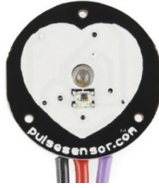
Figura 4.4 sensor de pulso AMPED que incorpora un foto detector y un led.
