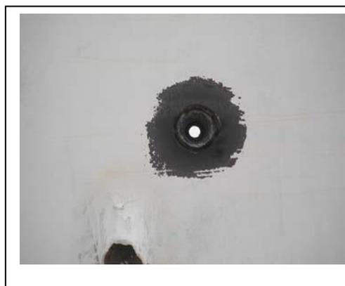
Sobre las planchas de acero igualmente penetró limpiamente atravesando las dos planchas.
