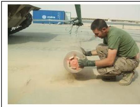
Otro aspecto a destacar fue el desgaste excesivo sufrido por las coronas propulsoras que hubo que girarlas tras 1000 km aproximadamente, sin embargo sorprendió de manera positiva el comportamiento de las zapatas y las ruedas de marcha que han aguantado toda la misión sin sufrir grandes desgastes.
