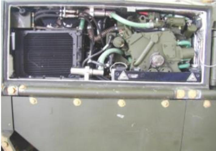
Ilustración 6. Unidad de Potencia Auxiliar. Fuente: A-213 Manual Didáctico Leopard 2E ACINF.
