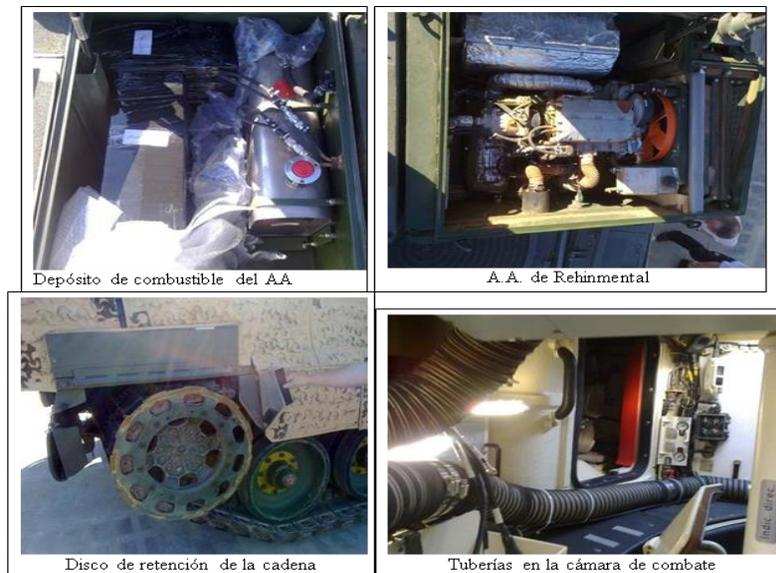
*Ilustración 9. Modificaciones realizadas en el carro de combate I. Fuente: Informe Arabia Saudí.*
