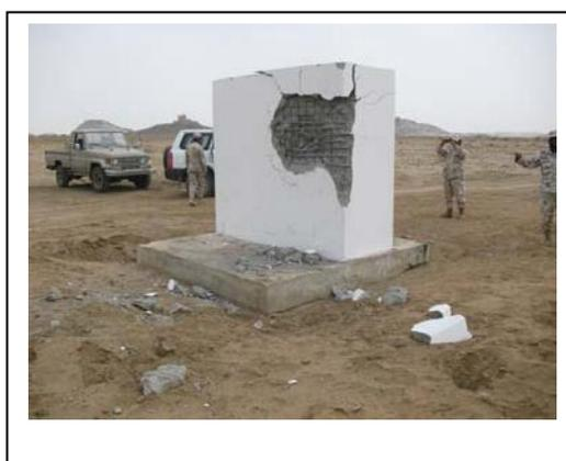
Sobre el muro de hormigón la munición perforó limpiamente el muro pero sin causar demasiados destrozos en el mismo.
