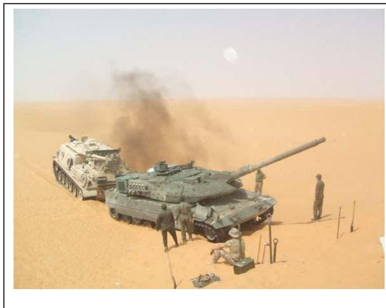
Finalmente para poder montar la cadena evitando que se volviera a hundir en la arena fue necesario crear un terreno duro, esto se consigue simplemente con agua.
