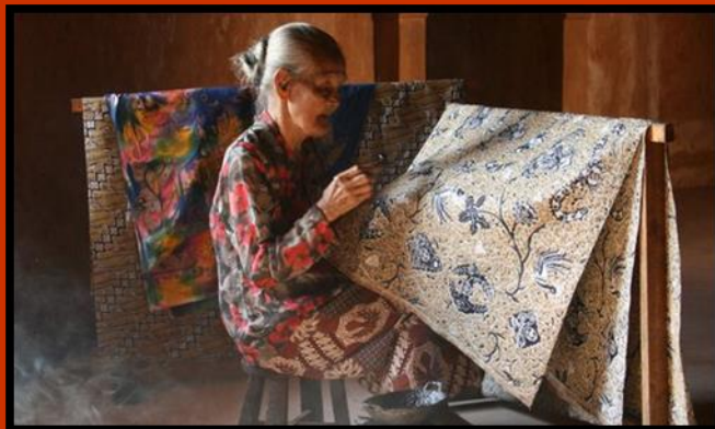
Gambar 4. Gawangan yang digunakan pada proses membatik tulis Sumber : https://m.diadona.id/beauty/
