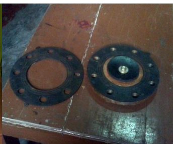
Gambar 4. Klep masuk air ke dalam badan pompa
