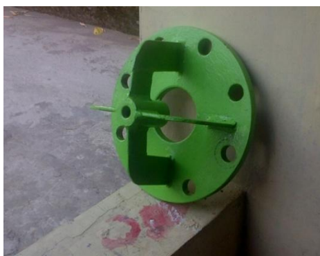
Gambar 6. Kepala klep keluar air dari badan pompa
