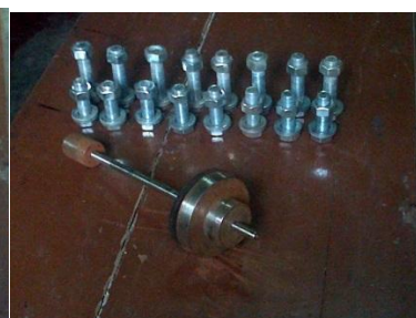
Gambar 5. Klep keluar air dari pompa ke pipa output
