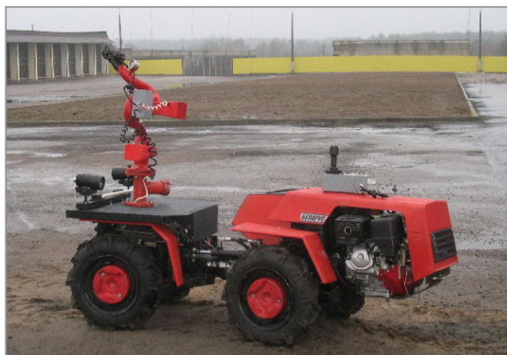
Рис. 1. Общий вид робототехнического комплекса на базе шасси «Беларус-132»
