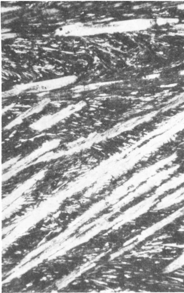
Photo 1 Spinifexstruktur (Klinopyroxen) eines Komatiits aus Karelien, parallel zur vorherrschenden Längserstreckung der Nadeln, Nic. gekreuzt, Nadeldurchmesser ca. 0,5 mm
