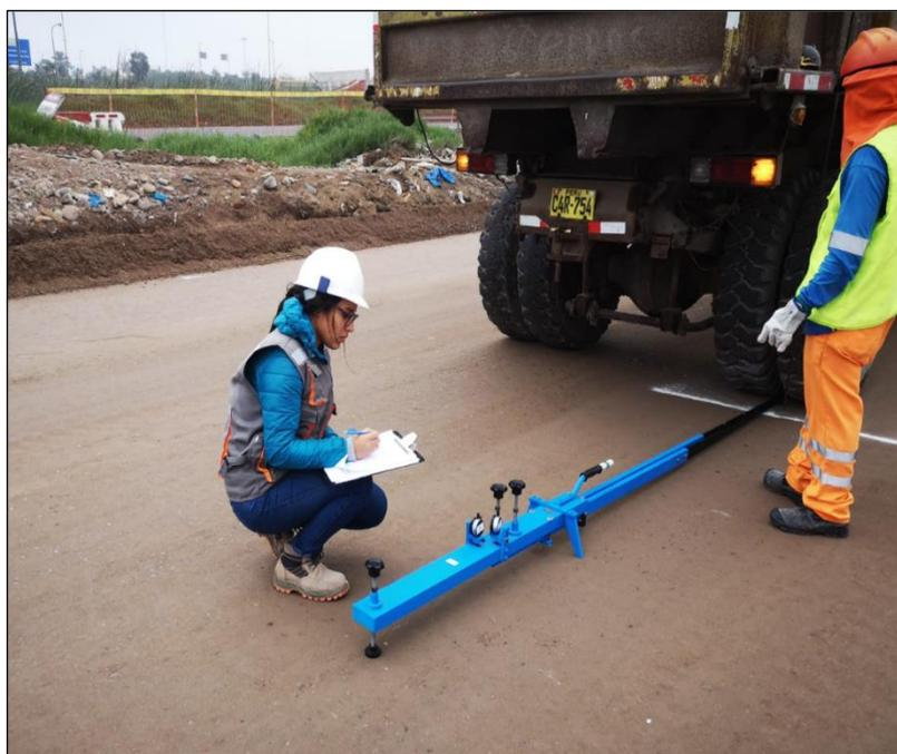
Figura 2. Viga Benkelman brazo 2:1
