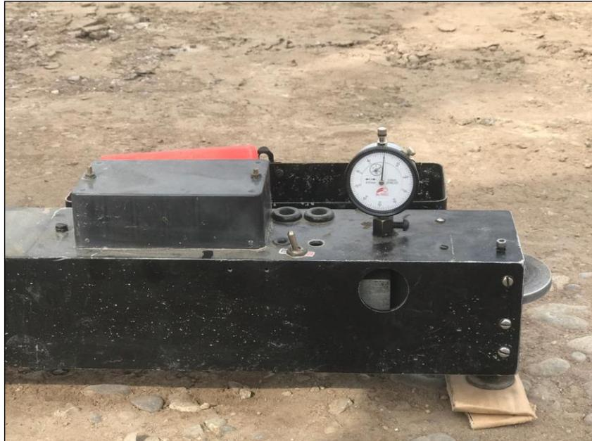
**Figura 5. Detalles de la viga Benkelman.**
