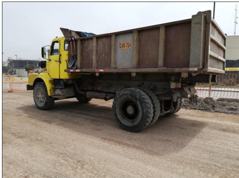
**Figura 6. Camión cargado para ensayos deflectométricos.**
