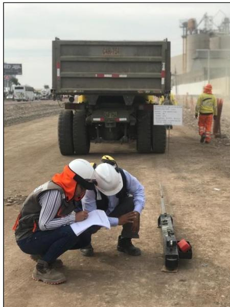
Figura 1. Tomando lecturas de viga Benkelman.
