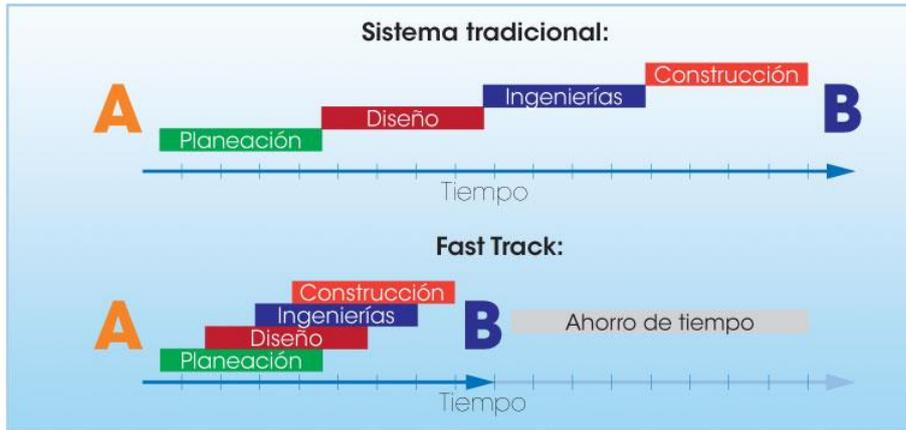
Figura 1: Comparación entre el sistema tradicional y el Fast-Track
