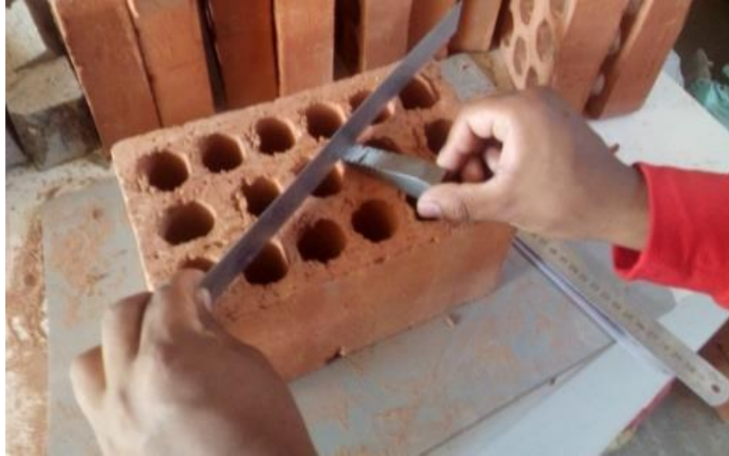
Figura 18. Medida cóncava del ladrillo.
