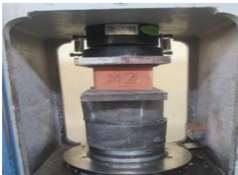
Figura 16. Ensayo de la compresión axial del ladrillo.
