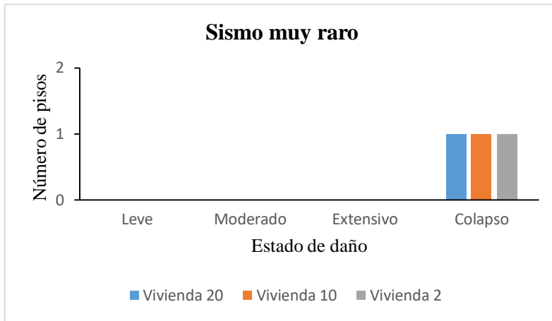
Figura 154. Resultado de los estados de daño de las edificaciones para un sismo muy raro.
