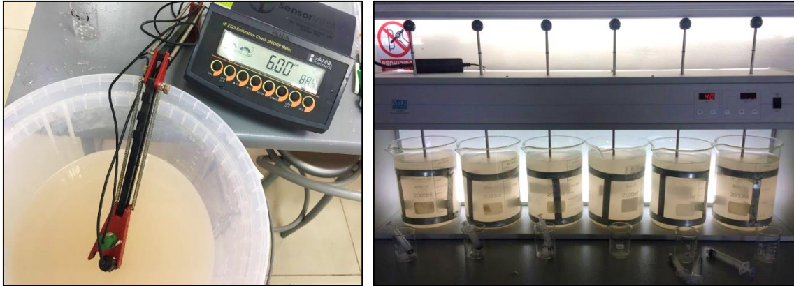
Figura 30. Medición de pH en agua patrón (a) y Test de jarras aplicando las variables independientes (b).
