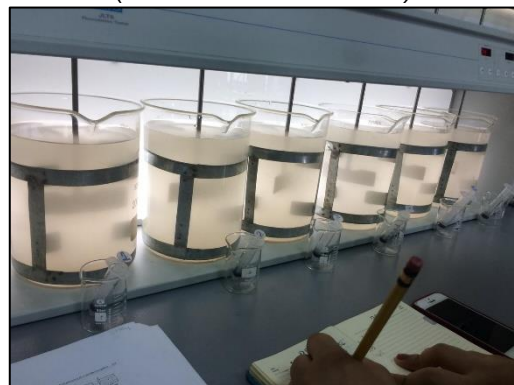
Colocación de dosis de sulfato de aluminio y almidón de pituca
