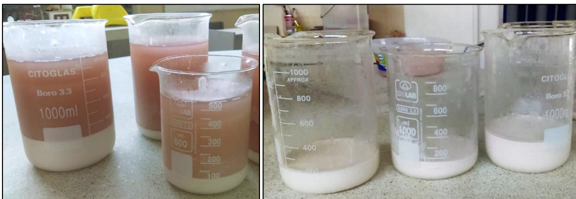
Figura 23. Material acuoso de almidón de pituca luego de sedimentar.
