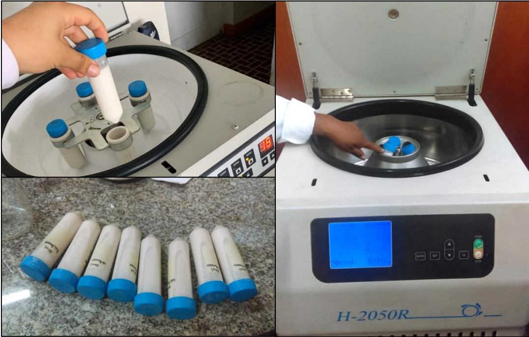
Figura 24. Material acuoso de almidón de pituca en el equipo de centrifuga.
