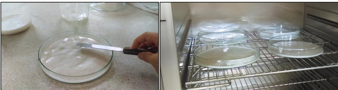
Figura 25. Material acuoso de almidón de pituca en la estufa.
