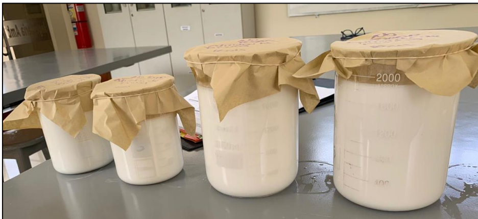
Figura 22. Vasos precipitados con lechada de almidón de pituca antes de sedimentar.
