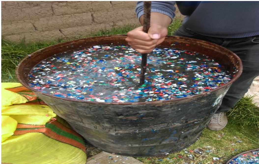
Lavado del PET para retirar la escoria que no servira
