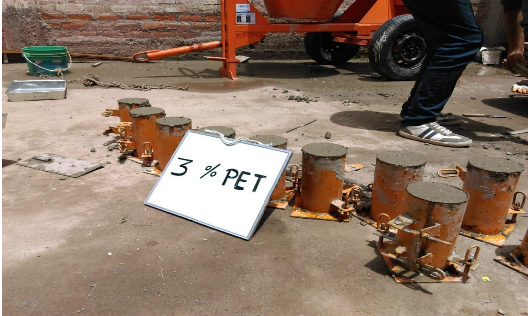
Rellonado en las briquetas de la mezcla
