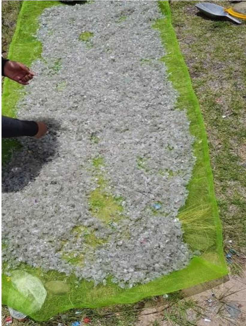
Figura 10. Secado de las hojuelas de PET (fuente propia).
