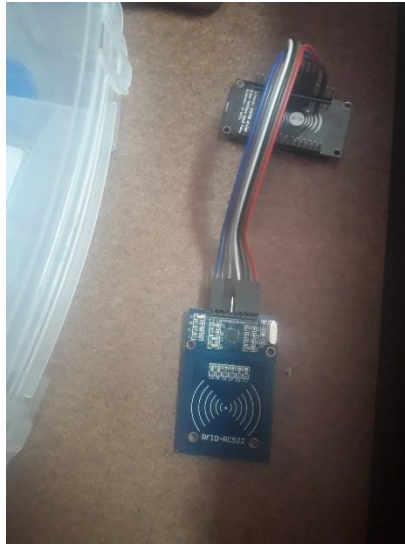
Figura 32. Integración de ESP8266 y MFRC522.
