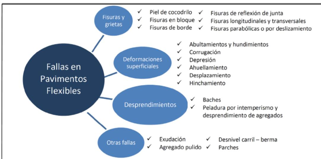
Figura 56. Fallas en pavimentos flexibles. Fuente: (Tacza Herrera & Rodríguez Paez, 2018).
