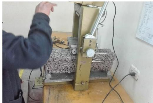
*Fotografía 8. Vigas de Flexión elaboración y rotura*
