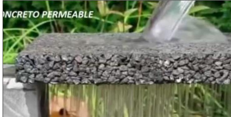
*Figura 5. Pavimento de Concreto Poroso. Adaptado de Youtube.*
