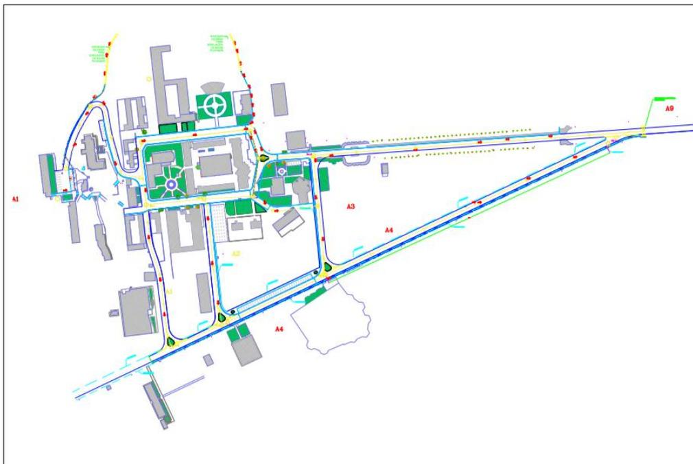
Figura 31. Red de Evacuación del Drenaje Pluvial (Elaboración propia).
