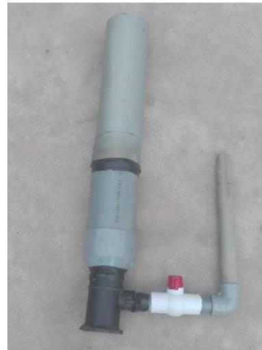
*Fotografía 10. Permeámetro elaborado para ensayos de Permeabilidad*
