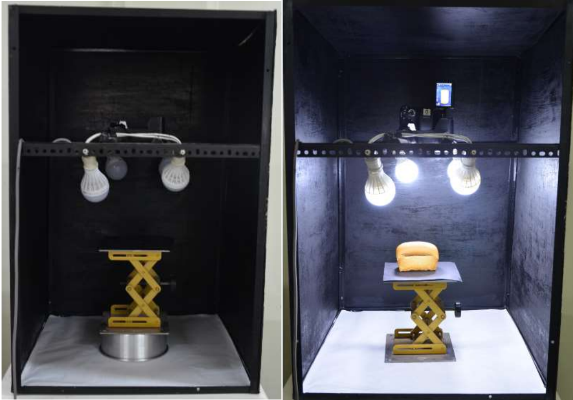
Imagen del sistema de adquisición de imágenes para en análisis de color
