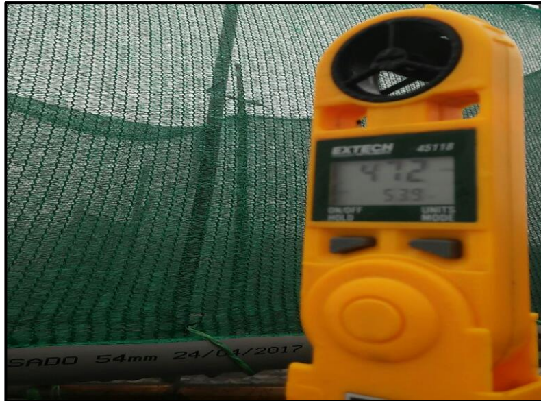
Figura 32. Medición de velocidad de viento con anemómetro digital (Modelo: 45118).
