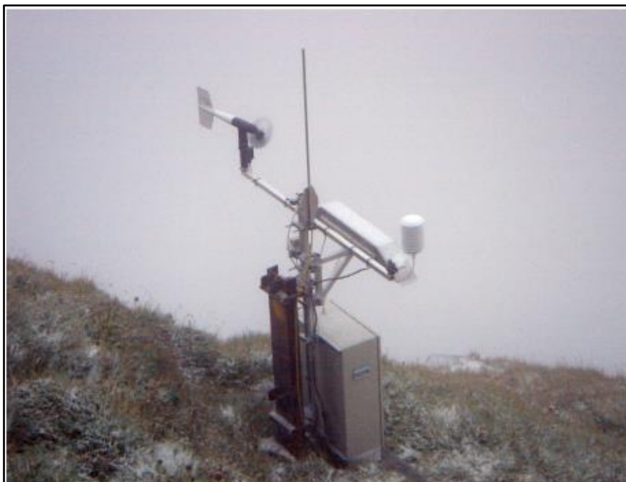
Figura 19. Vista del MiniCASCC, montado en el sitio de Niesen Kulm. Con el anemómetro y el higrómetro más la protección contra rayos barra. Fuente: Michna (2007).
