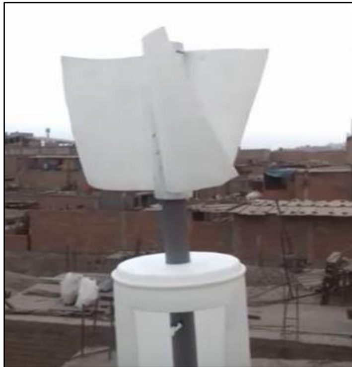
Figura 20. Turbina eólica generadora de agua potable Fuente: Ciencia (2017)
