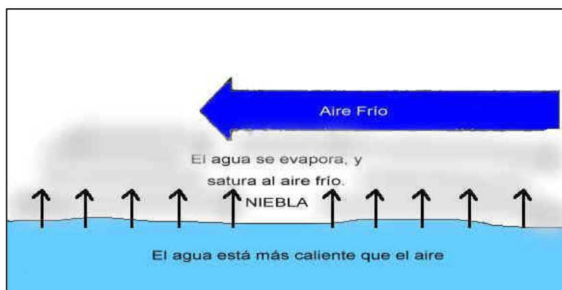
Figura 7. Esquema de niebla de vaporización
