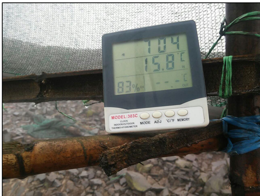
Figura 31. Registro de temperatura y humedad relativa con instrumento Higrómetro digital (serie 445703).
