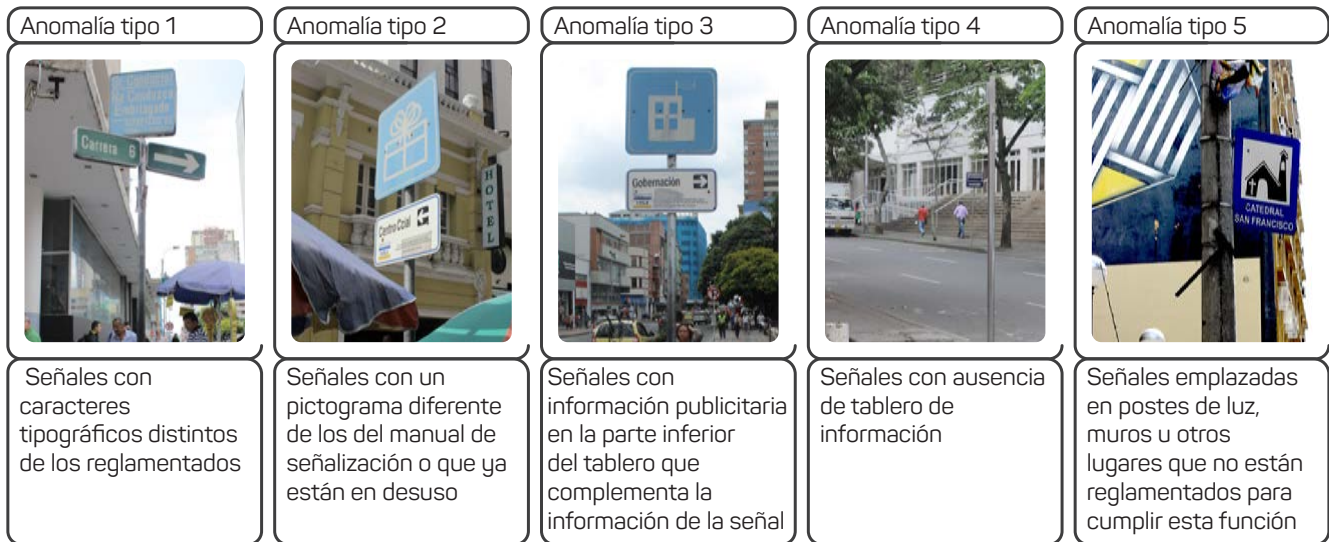
Figura 29. Tipos de anomalías identificadas en el sistema de señales viales informativas.
