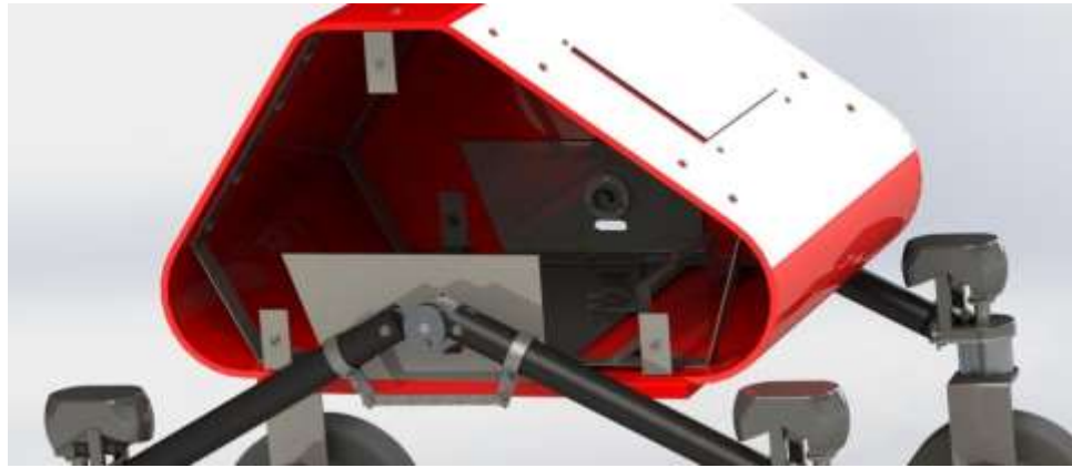
Fig. 57. CAD de interior del robot
