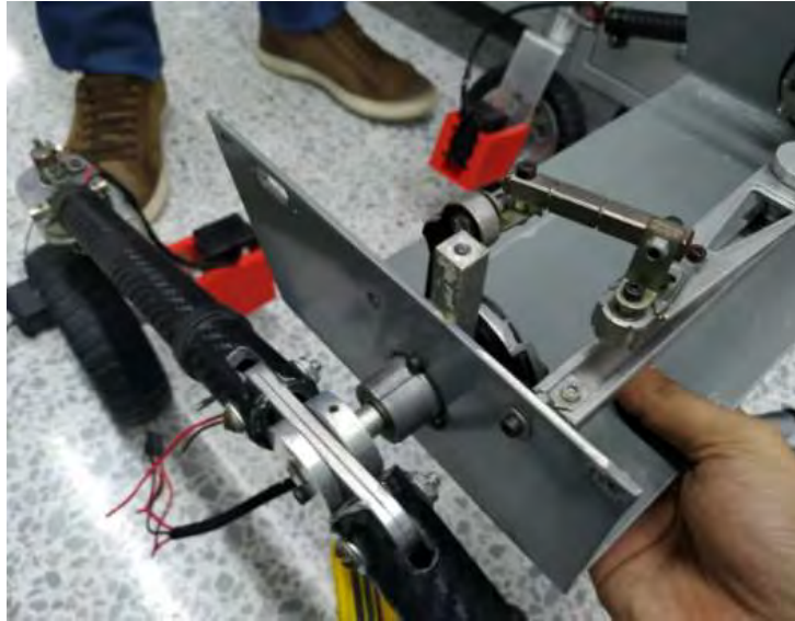
Fig. 46. Sistema de estabilización del robot.
