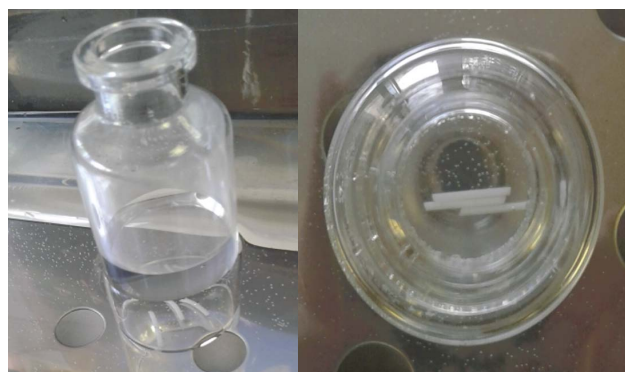
Рис. 2. Процедура экстракции бактериальных эндотоксинов с поверхности имплантата в водную среду
