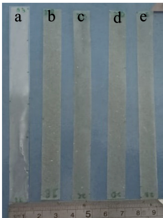
Gambar 1. Sampel dengan variasi konsentrasi serat a) 0%, b) 2%, c) 4%, d) 6% dan e) 8%.
