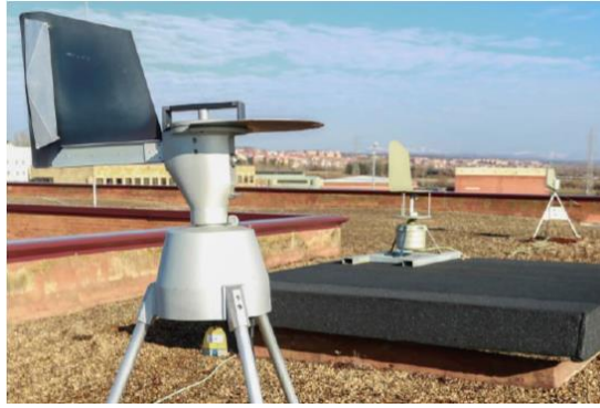
Figura 2. Captador volumétrico tipo Hirst ubicado en la azotea del Hospital General Universitario de Alicante.
