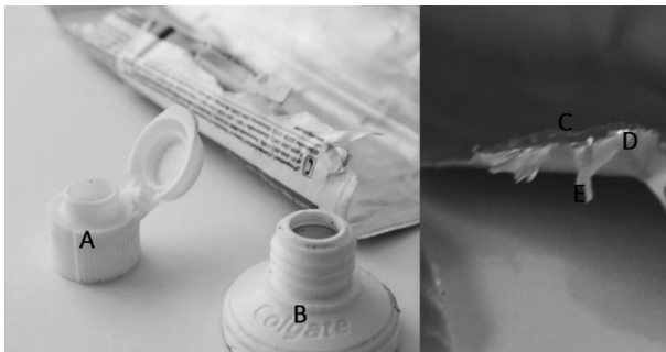
Figura 1. Envase de la crema de dientes desensamblado.
