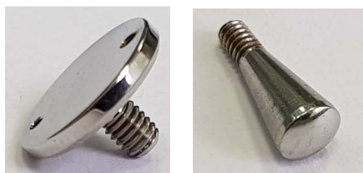
Рис. 9. Образцы изделий из коррозионно-стойкой стали после полирования в импульсном процессе электролитно-плазменной обработки
