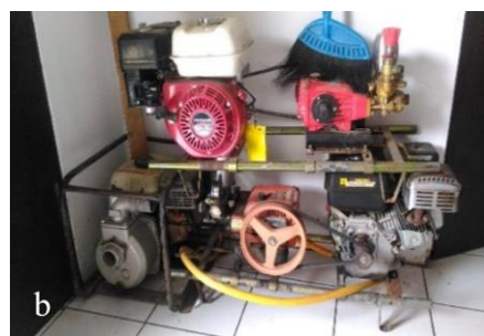
Gambar 12 (a) Pompa jinjing, (b) Pompa induk
