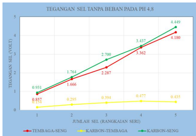
Gambar 5 Grafik tegangan sel elektrokimia air gambut pada pH 4,8
