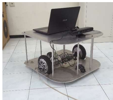
Gambar 4.17 Peletakan Kinect dan laptop pada frame AIV
