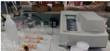
Gambar 4. Analisis Amonium Menggunakan Spektrofotometer
