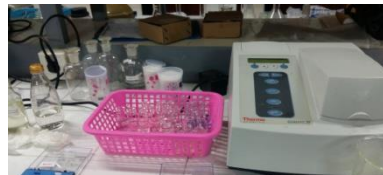
Gambar 5. Analisis Fosfat Menggunakan Spektrofotometer
