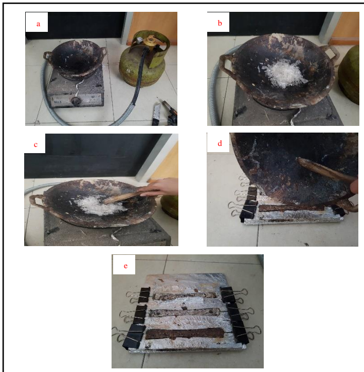
Gambar 3.14 Proses pembuatan spesimen uji tarik (a) persiapan alat (b) melting (c) mixing (d) penuangan (e) solidifikasi
