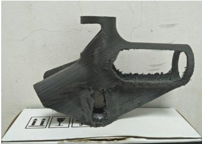
Gambar 4.10 Produk sambungan antara Top Tube dan Seat Tube .
