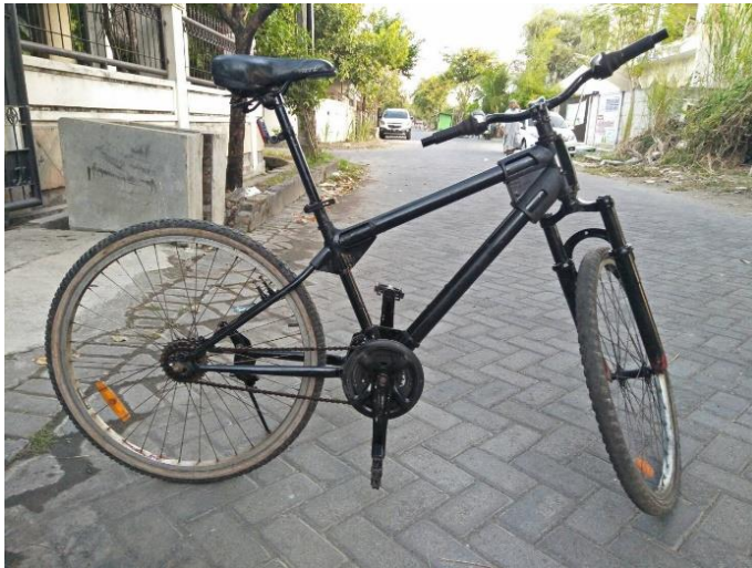
Gambar 4.11 Hasil assembly antara part penyambung dengan frame sepeda.
