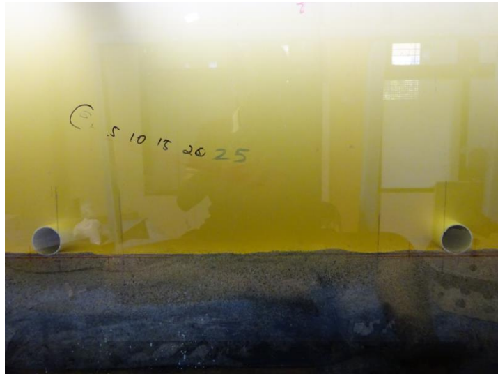
Gambar 4.33 Kondisi t = 0 menit eksperimen scouring pada dua pipa berjarak 60 cm kondisi in-trench 4 mm dengan H_{avg} = 8,23 cm dan T_{avg} = 1 s.
