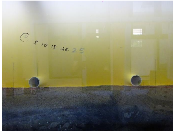
Gambar 4.13 Kondisi t = 0 menit eksperimen scouring pada dua pipa berjarak 40 cm kondisi meletak dengan H_{avg} = 8,15 cm dan T_{avg} = 1,03 s
