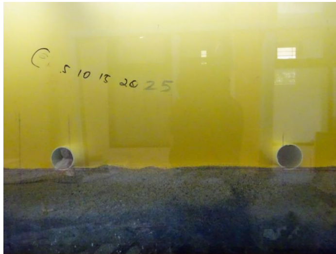
Gambar 4.17 Kondisi t = 0 menit eksperimen scouring pada dua pipa berjarak 40 cm kondisi in-trench dengan H_{avg} = 7,29 cm dan T_{avg} = 0,99 s
