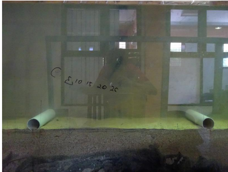
Gambar 4.25 Kondisi t = 0 menit eksperimen scouring pada dua pipa berjarak 60 cm kondisi in-trench 4 mm dengan H_{avg} = 5,14 cm dan T_{avg} = 0,94 s
