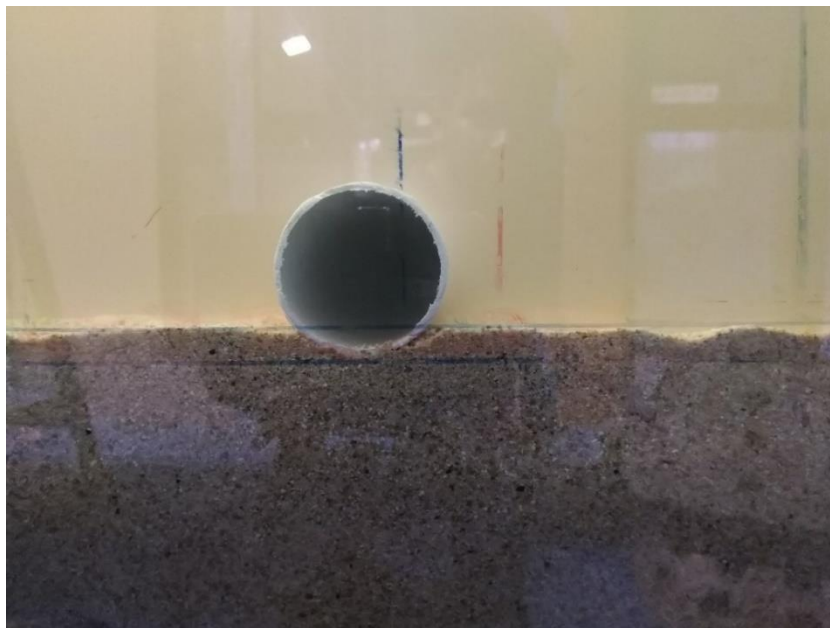
Gambar 4.27 Kondisi pipa saat t = 25 menit, H = 13cm, v= 10cm/s ( in – trench )
