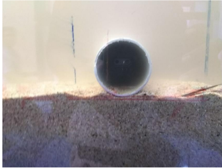
Gambar 4.21 Kondisi Pipa saat t = 25 , H = 11\text{cm} , v = 13\text{cm/s} ( in – trench )
