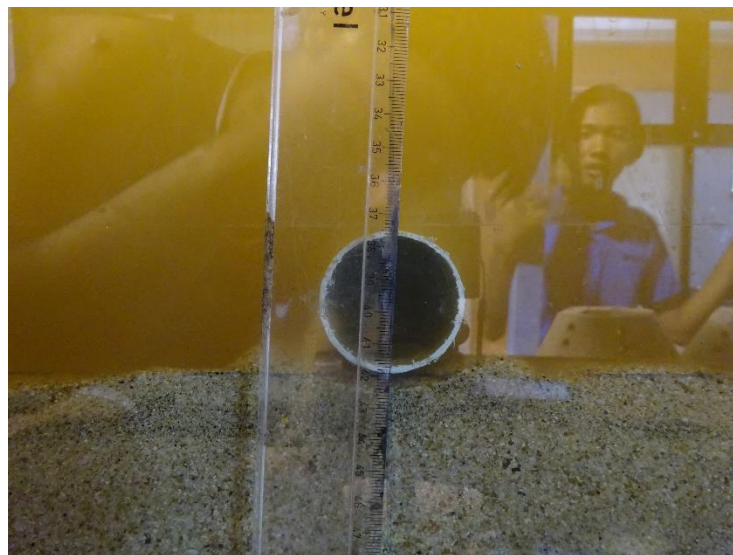
Gambar 2. Kondisi H = 13 , v = 10\text{cm/s} , e/D = 0
