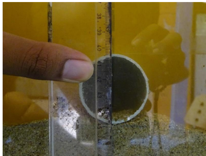
Gambar 4.19 Kondisi pipa saat t = 25 menit, H = 13cm, v= 10cm/s ( in – trench )
