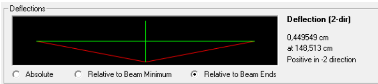
Gambar 4. 16 Lendutan Balok Utama Tangga
