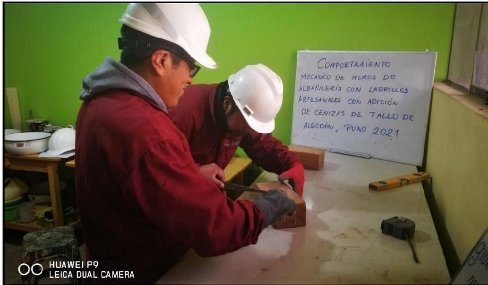
Fig. 17. Realizando Ensayo de Alabeo
