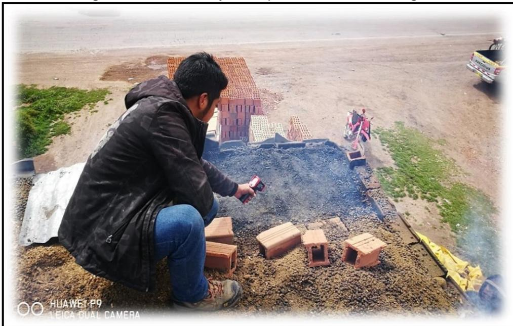
Figura 14 Midiendo la temperatura de calcinación de las cenizas de tallo de algodón
