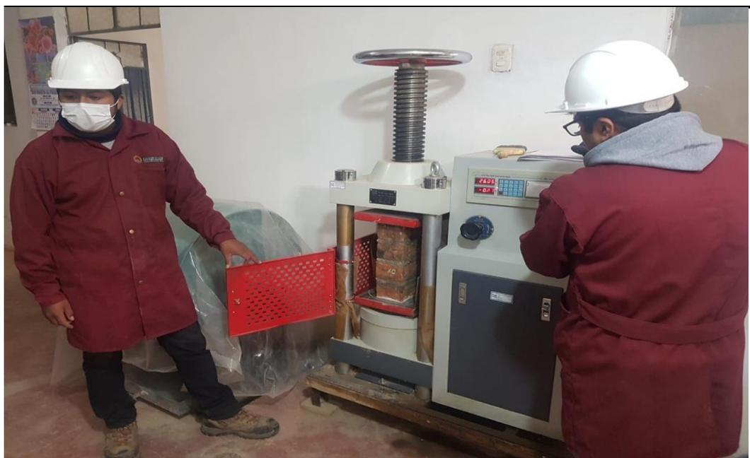
Fig. 24. Compresión Axial
