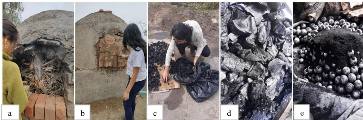
Figura 9. Elaboración de biocarbón activado de poda. a) Llenado del horno pirolizador, b) sellado del horno, c) extracción del biocarbón hecho en 04 horas por pirolisis lenta a 500°C – 600°C, d) estabilización del biocarbón antes de ser activado y e) biocarbón activado en proceso de molienda.
