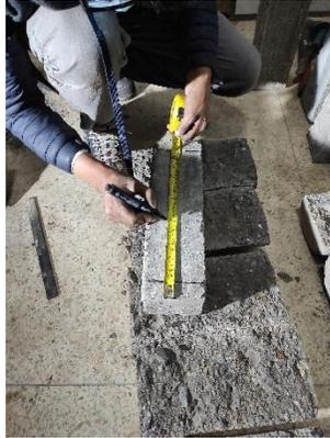
**Fotografía 31:** Distribuyendo medidas a tercios para el ensayo a flexión
