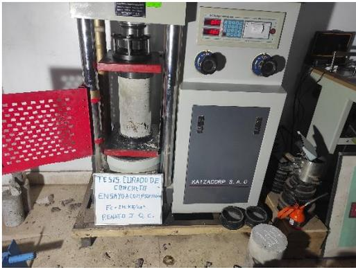
**Fotografía 25:** Rotura de testigos a compresión
