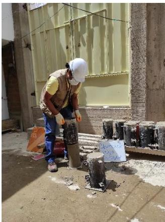
**Fotografía 15:** Desencofrado de los testigos
