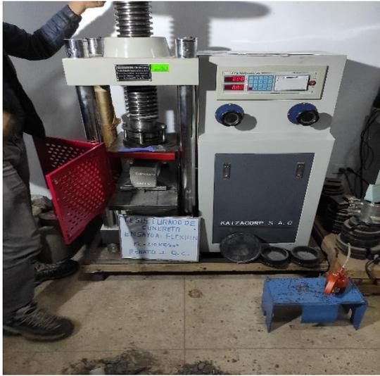
**Figura 16. Rotura de testigos**
