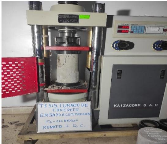
Figura 12. Rotura de testigos
