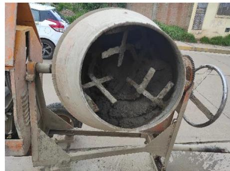
**Fotografía 6:** Dosificando el concreto para la elaboración de testigos
