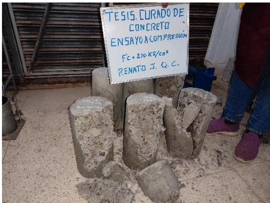
**Fotografía 27:** Rotura de testigos a compresión
