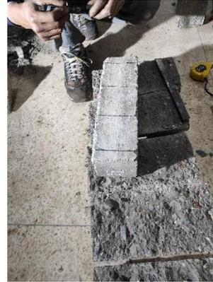
**Fotografía 32:** Distribuyendo medidas a tercios para el ensayo a flexión
