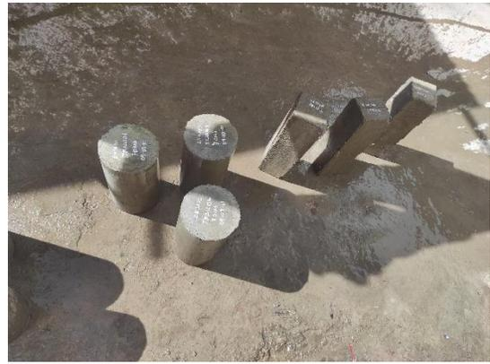
**Fotografía 20:** Testigos de concreto
