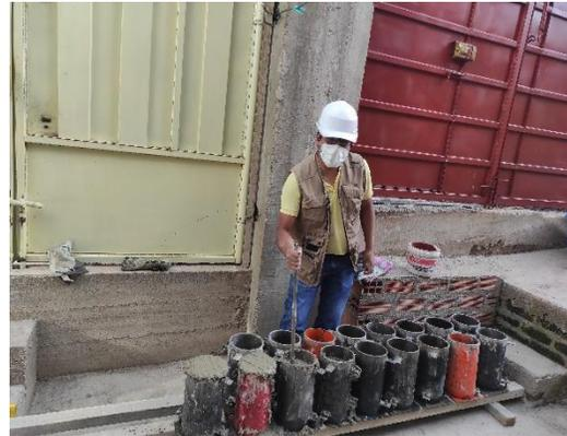
**Fotografía 10:** Elaboración de testigos de 15 cm de diámetro y 30cm altura
