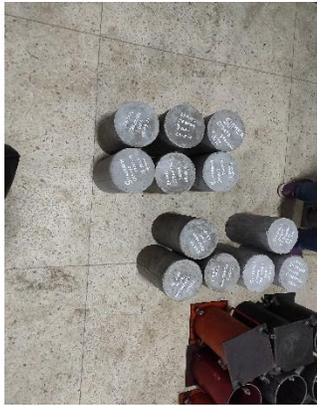
**Fotografía 19:** Testigos de concreto
