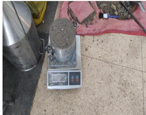
**Fotografía 4:** Peso de la muestra para el diseño de mezclas
