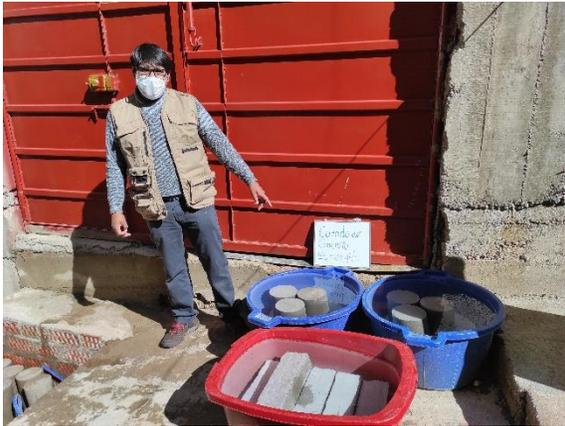
*Figura 10. Curado de concreto sumergido*
