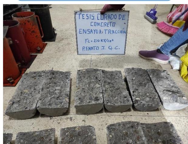
**Fotografía 30:** Rotura de testigos ensayo a tracción
