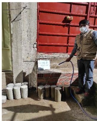
**Fotografía 17:** Curado de los testigos por roceado
