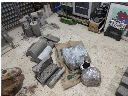
**Fotografía 39:** Rotura de Testigos a compresión y tracción
