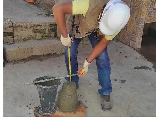
**Fotografía 8:** Ensayo de slump para el control de asentamiento.
