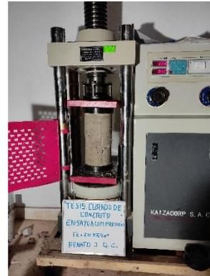
**Fotografía 26:** Rotura de testigos a compresión
