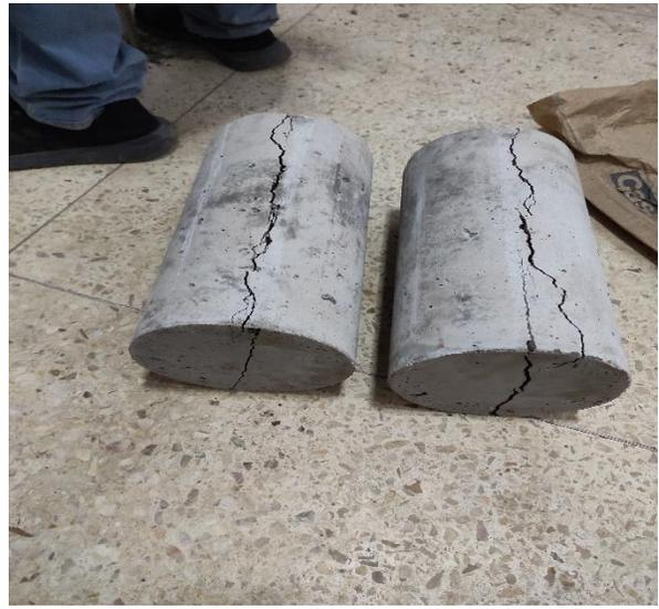
Figura 15. Rotura de testigos
