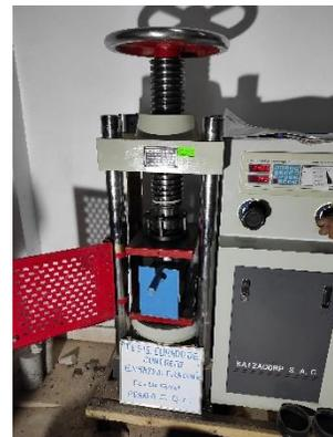
**Fotografía 28:** Rotura de testigos ensayo a tracción
