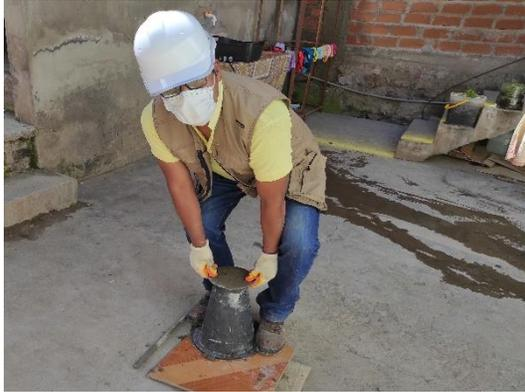
**Fotografía 7:** Ensayo de slump para el control de la dosificación
