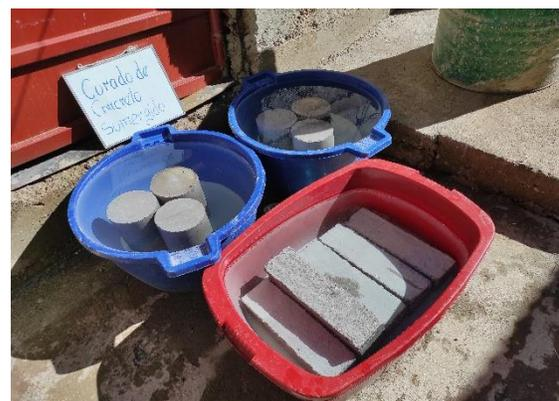
**Fotografía 18:** Curado de los testigos por el método sumergido
