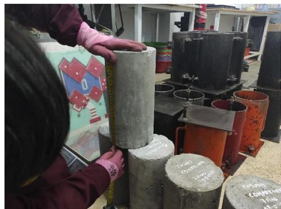
**Fotografía 24:** Medición de la altura del testigo.
