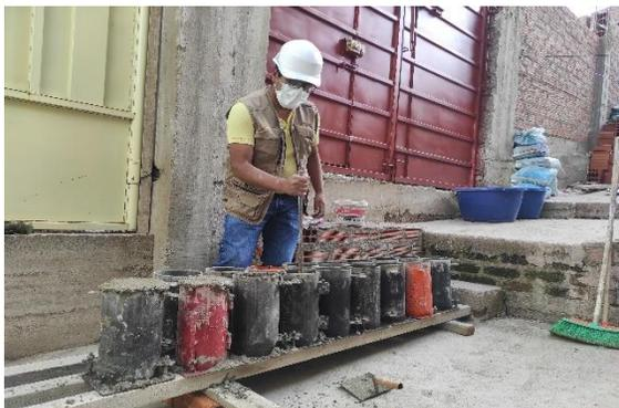
**Fotografía 11:** Elaboración de testigos con el respectivo chuseado.
