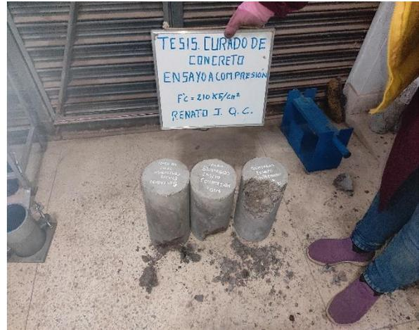
Figura 13. Rotura de testigos
