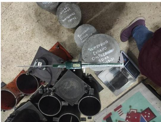
**Fotografía 23:** Medición del diámetro con el instrumento vernier
