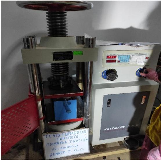
Figura 14. Rotura de testigos
