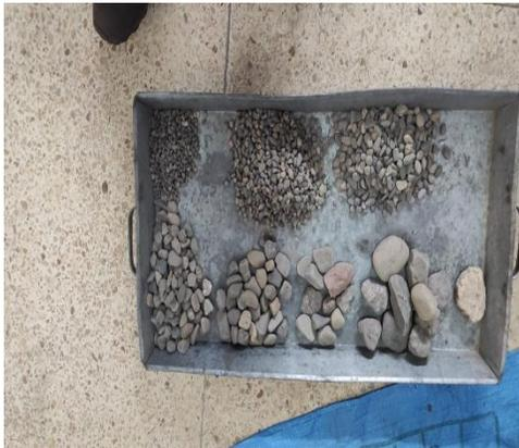
**Fotografía 3:** Pesos retenidos del agregado para el diseño de mezclas
