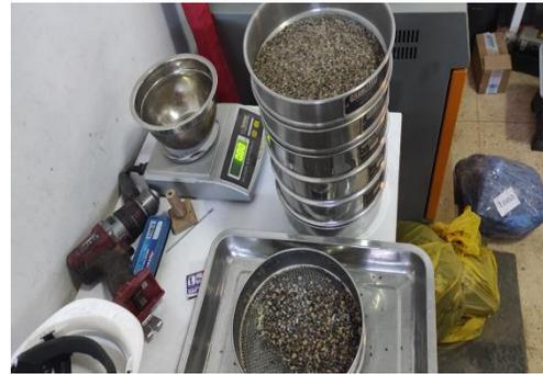
**Fotografía 2:** Tamizado del agregado para el diseño de mezclas.
