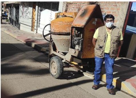
**Fotografía 5:** Maquina mezcladora para la dosificación del concreto
