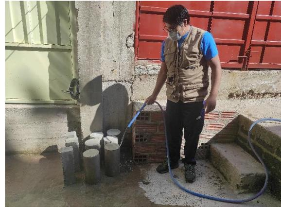
*Figura 11. Curado de concreto por roceado*
