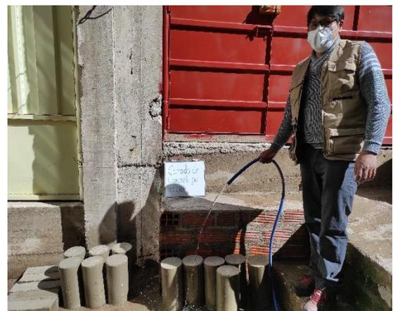
Figura 8. Curado de concreto sumergido    Figura 9. Curado de concreto por roceado
