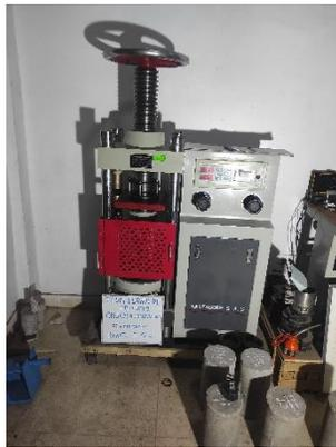
**Fotografía 21:** Maquina compresora para ensayos
