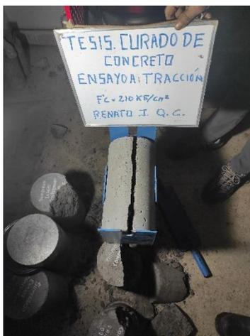
**Fotografía 29:** Rotura de testigos ensayo a tracción
