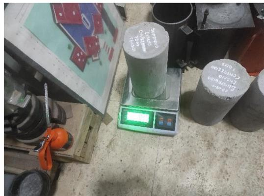
**Fotografía 22:** Testigos de concreto pesando en gr.
