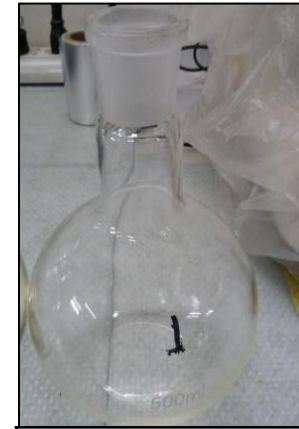
FOTO 35: balón sin presencia de aceites y grasas después de pasar la muestra final por el proceso del método de soxhlet.
