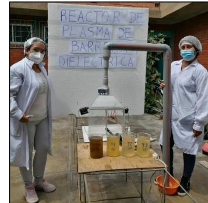
FOTO 48: Reactor de plasma de barrera dieléctrica con las muestras finales después de los tratamientos.
