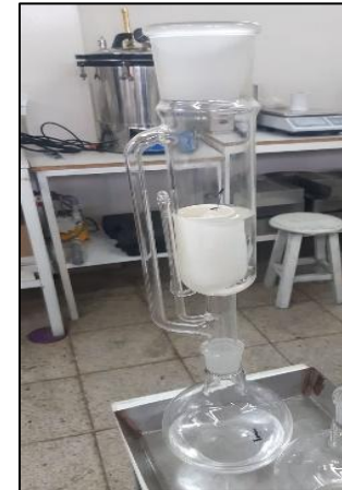
FOTO 32: Cámara de extracción con hexano y el cartucho celulosito con el filtro dentro (que se filtró en QUISTAZO).
