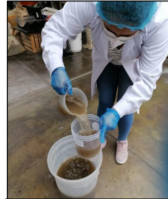
FOTO 8: Tomamos la unidad muestral de 2 litros, para análisis de caracterización de la muestra inicial.
