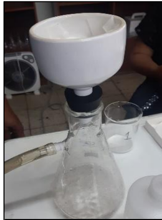
FOTO 31: Filtración de la muestra final en el QUITAZATO con filtro whatman N° 40 después de aplicado el reactor de plasma.
