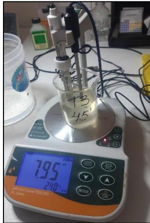
FOTO 75: Primero calibramos el multi-parametro, para medir el pH con buffer 4, 7, 10 de Ph del tratamiento 3: 45 min.
