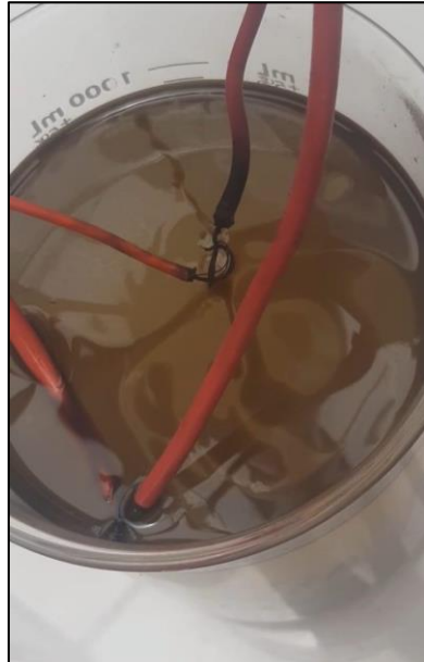
FOTO 61: Podemos notar en la muestra partes claras, por la eliminación de aceites y grasas del agua residual producto de la exposición a 15000 voltios de corriente eléctrica a alta frecuencia.
