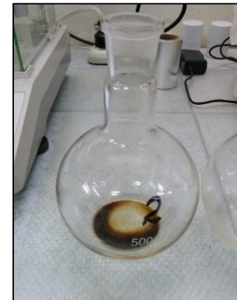
FOTO 29: balón con aceites y grasas resultantes después de pasar la muestra inicial por el proceso del método de soxhlet.
