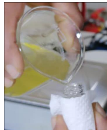
FOTO 20: Colocamos la muestra de agua en la celda del equipo del Tubímetro
