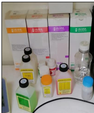
FOTO 16: Calibramos el equipo con Buffer 4, 7, 10 de pH, marca Hanna.
