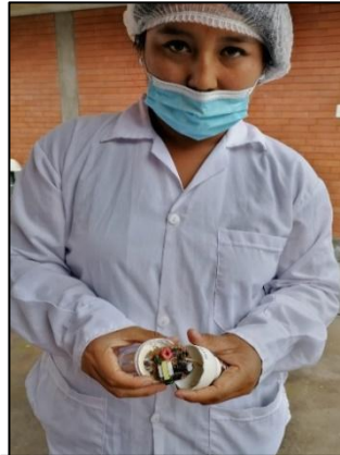
FOTO 43: Abrimos el foco ahorrador y retiramos la placa analógica para utilizarla en el reactor.
