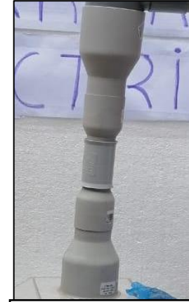
FOTO 45: Sistema de salida o sistema Venturi por donde saldrá el material particulado.
