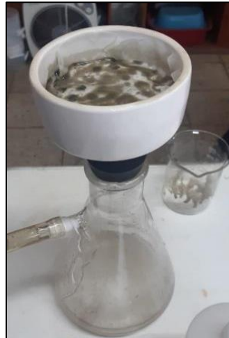
FOTO 25: Filtración de la muestra inicial con filtro whatman N° 40 en el QUITAZATO.
