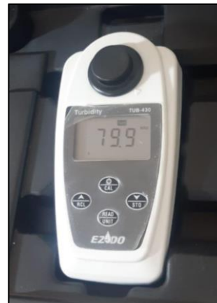
FOTO 79: Medimos la Turbidez con el turbidmetro del tratamiento 3: 45 min.
