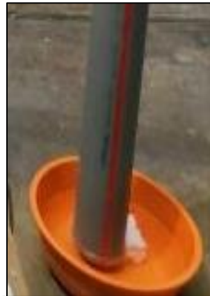
FOTO 47: Sistema de agua donde se quedará el material particulado y los contaminantes por burbujeo y solo saldrá al ambiente aire limpio.
