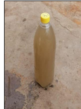
FOTO 5: Primer frasco con la muestra de agua residual tomada, para su posterior etiquetado, en total se tomó 10 litros de muestra.
