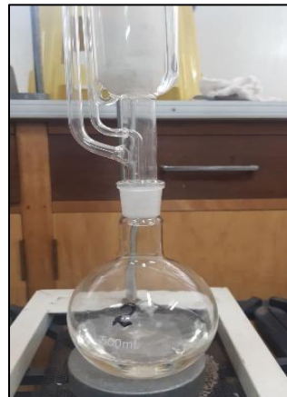
FOTO 28: el hexano ebulliciona con la muestra inicial y empiezan a verse los reflujos constantes.
