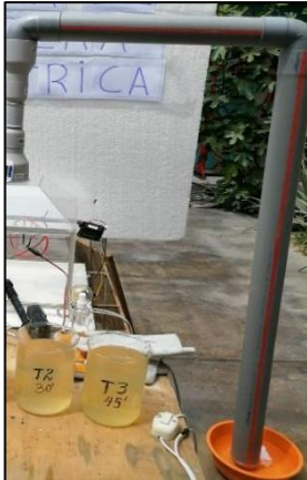
FOTO 46: 2 Codos de 3", 1 tubo de \frac{1}{2} m de 3" y 1 tubo de 1 m de 3".
