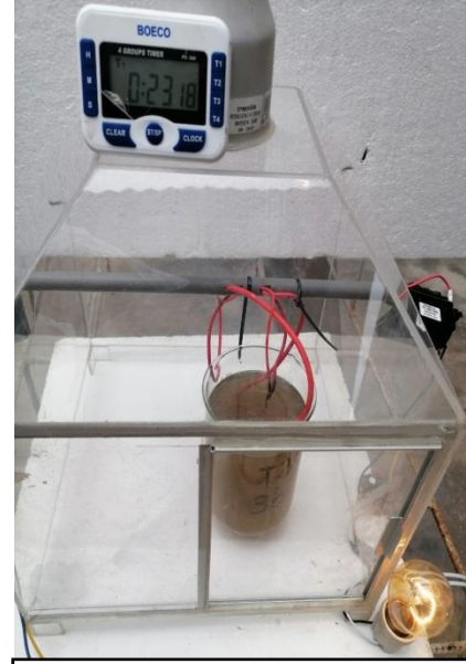
FOTO 58: Después de pasados de 23 min de tratamiento, el agua residual se torna más clara, producto de la eliminación de aceites y grasas.
