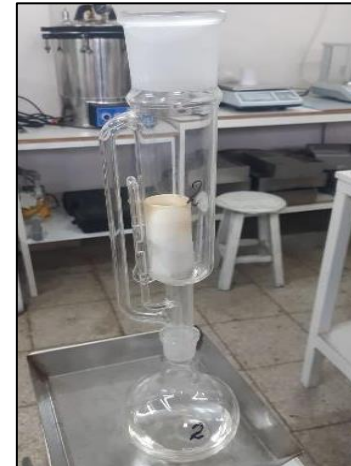
FOTO 26: Cámara de extracción con hexano y cartucho celulósico con el filtro dentro (que se filtró en QUISTAZO).
