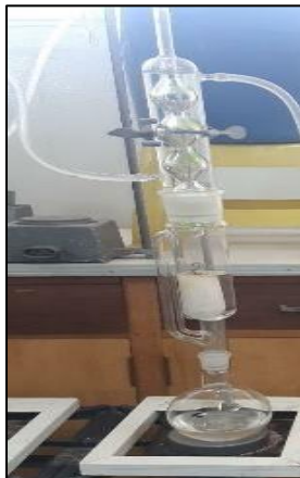
FOTO 27: Proceso de método soxhlet por 45 min.
