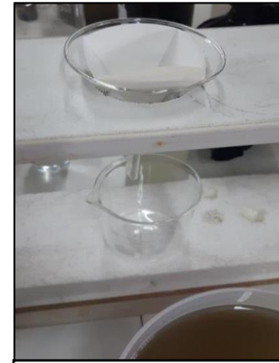
FOTO 11: Colocamos el papel filtro en el embudo que se encuentra en el digestor.
