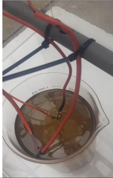
FOTO 57: Se observa en la muestra partes claras, por la eliminación de aceites y grasas del agua residual producto de la exposición a 15000 voltios de corriente eléctrica a alta frecuencia.
