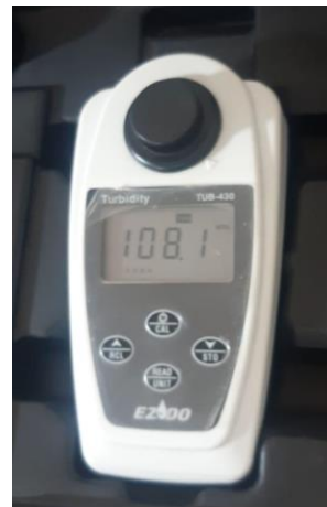
FOTO 74: Medimos la Turbidez con el turbidimetro del tratamiento 2: 30 min.
