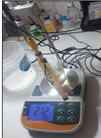
FOTO 71: Medimos la Conductividad eléctrica con el multi-parametro introduciendo el electrodo de CE del tratamiento 2: 30 min.
