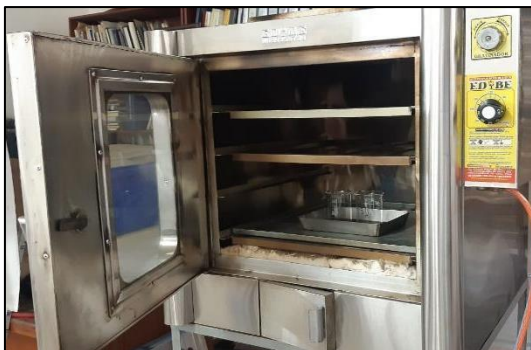
FOTO 22: Colocamos 2 vasos de precipitados en la estufa a 105 °C por 1 hora para medir los Solidos Totales y Solidos Disueltos
