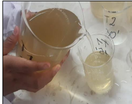
FOTO 65: Se tomó 100 ml de cada tratamiento de después de aplicado el reactor en 3 vasos de precipitados.
