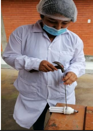
FOTO 42: Obtenemos la placa analógica extrayéndola de un foco ahorrador de 20 W de potencia.
