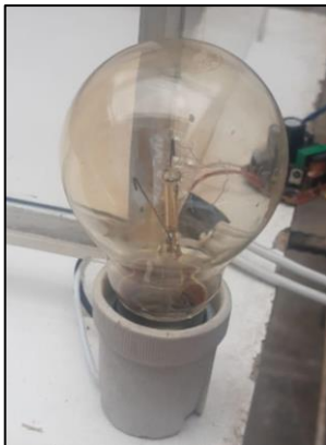
FOTO 39: Foco indicador de 220 voltios y 20 w de potencia.
