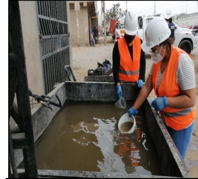
FOTO 3: Toma de muestra de agua residual del lavadero de radiadores y repuestos.
