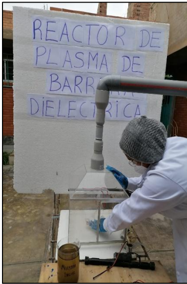
FOTO 49: Antes de empezar limpiamos correctamente la cabina del reactor.
