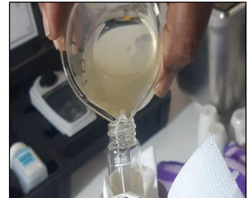
FOTO 69: llenado de la celda del turbimetro para medir la turbidez de los 100 ml del Tratamiento 1: 15 min.
