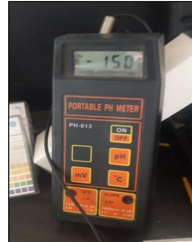
FOTO 77: Medimos el Potencial Redox, con el multi-parametro introduciendo el electrodo en la muestra del tratamiento 3: 45 min.
