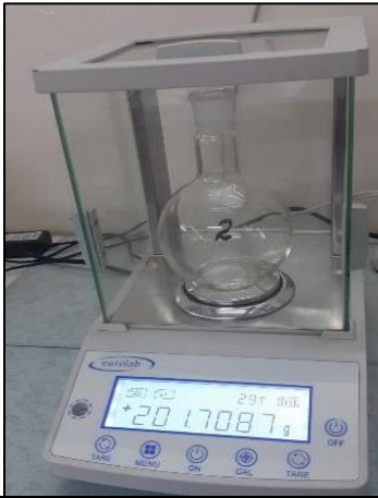
FOTO 24: Primero, lavamos y llevamos a la estufa el balón a 105°C y luego pesamos en la balanza analítica.
