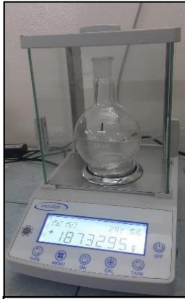
FOTO 30: Primero, lavamos y llevamos a la estufa el balón a 105°C y luego pesamos en la balanza analítica.
