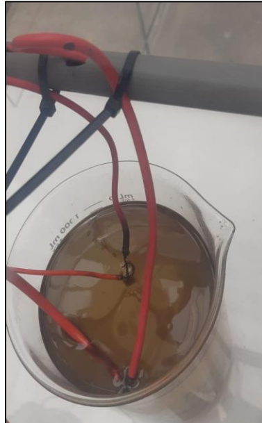
FOTO 53: Podemos notar en la muestra partes claras que significa la eliminación de aceites y grasas del agua residual producto de la exposición a 15000 voltios de corriente eléctrica a alta frecuencia.
