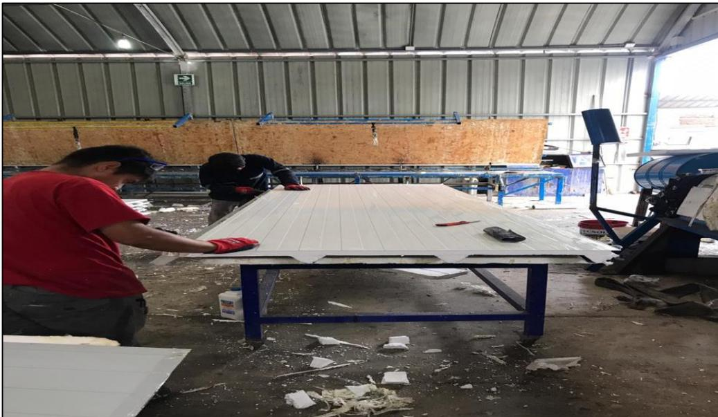
***Figura 21. Corte de la plancha de poliestireno***
