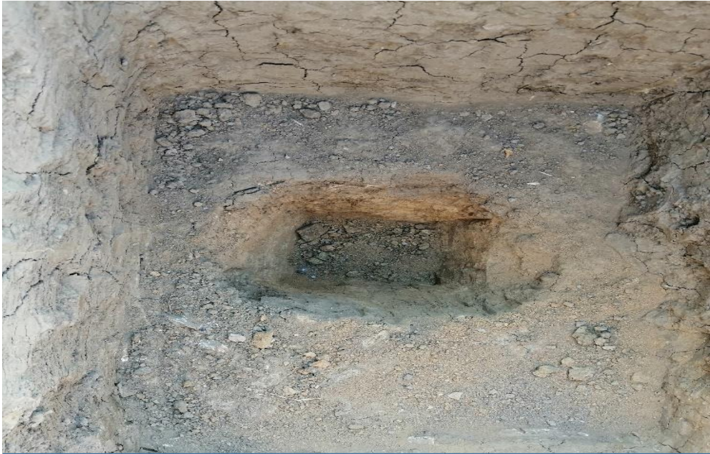
Foto N° 09. Excavación de Calicata para realizar el Test de percolación en el caserío de Cangrejera
