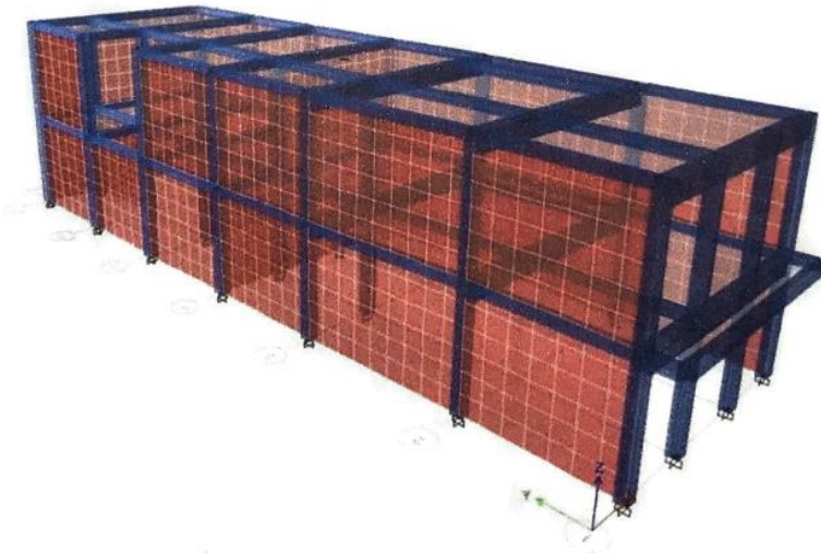
Vivienda N° 01: modelamiento estructural
