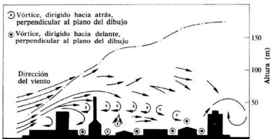
Figura.10 Efectos aerodinámicos de los edificios y topografía irregular.
