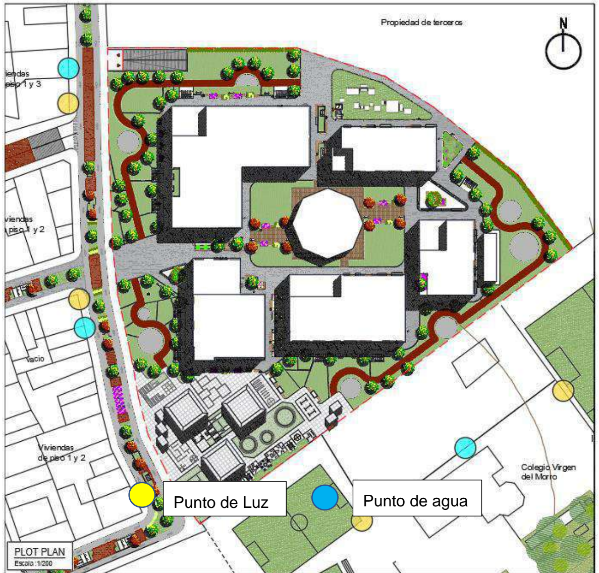
Figura 12: Plano de plot plan con la identificación de los puntos más cercanos de abastecimiento de luz y agua para el proyecto
