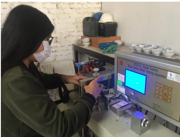
Figura 17. Laboratorio Ingeonort SAC., Ensayo de corte directo, 2020.
