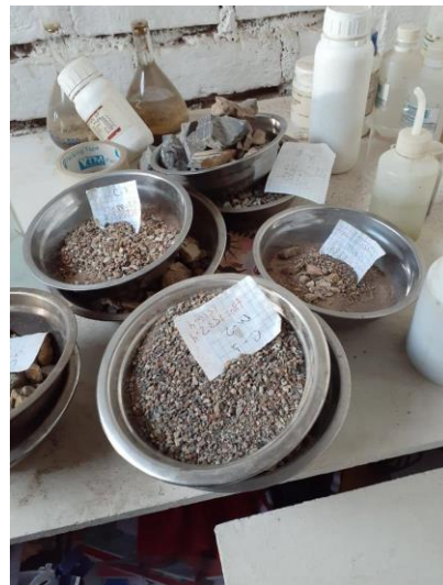
Figura 18. Laboratorio Ingeonort SAC., Material de ensayo de granulometría, 2020.
