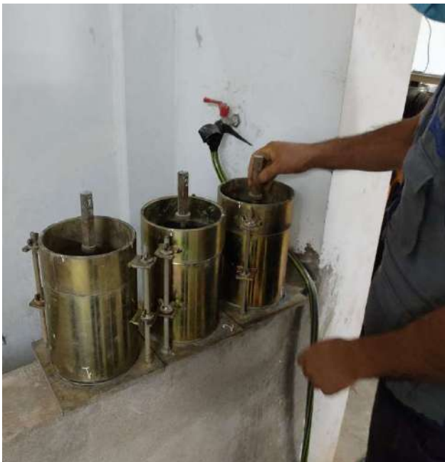
Se tiene los 3 moldes para sumergirlos en la poza previa y cada molde se medirá su expansión- Ensayo de CBR.
