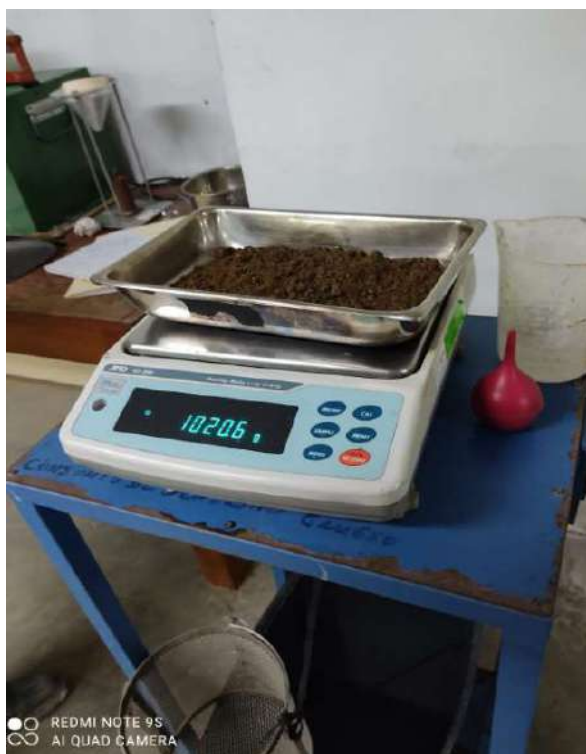
Peso de la muestra de suelo para llevar al horno, es el suelo que queda del molde donde se compactaron las 5 capas de suelo - Ensayo PROCTOR
