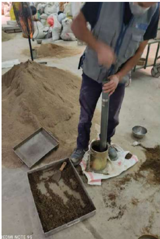
Compactando a los 56 golpes con el pisón- Ensayo de CBR.
