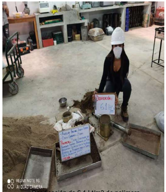
Dosificación de 6.1 Lt/m 3 de polímero acrílico de estireno - Ensayo de CBR.
