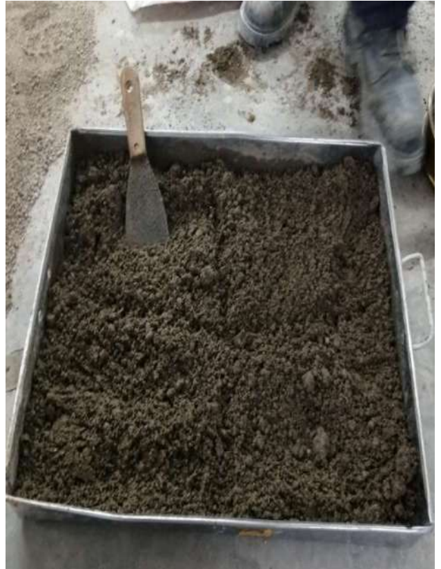
Cuarteo de la muestra de suelo homogenizada con el polímero- Ensayo de CBR.
