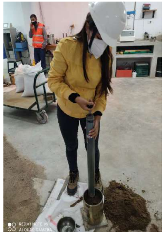
Apisonando la tercera capa de 56 golpes hasta la capa 5-Ensayo PROCTOR.
