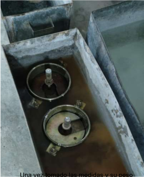
Una vez tomado las medidas y su peso respectivos midiendo la expansión de los moldes, se procede a sumergirlos por 72 horas- Ensayo de CBR.
