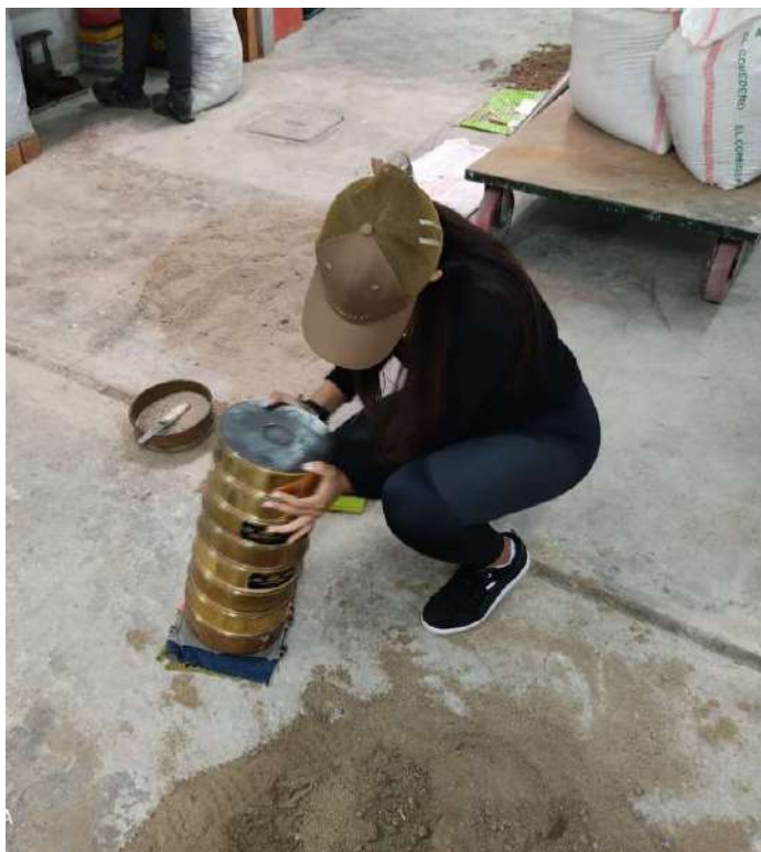
Tamizado de la muestra del suelo - Análisis Granulométrico ASTM D422
