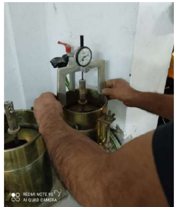
Midiendo la expansión del molde - Ensayo de CBR.
