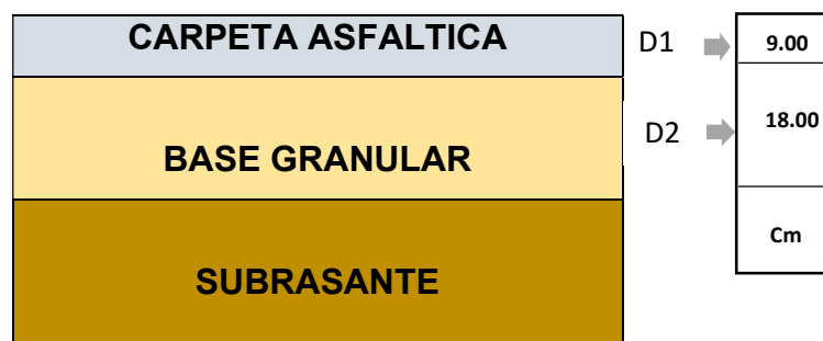
Figura 29. Diseño del pavimento flexible en estado natural + 8.2 Lt/m 3 .
