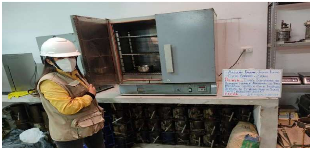
Figura 17. Proceso de contenido de humedad de la muestra.
