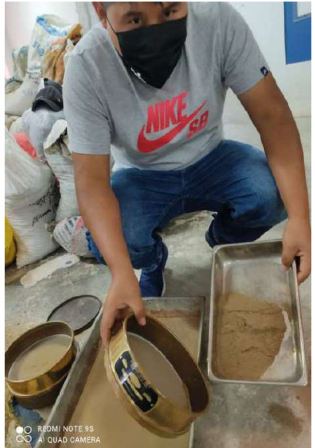
Retención en la malla N°100 de la muestra de suelo - Análisis Granulométrico
