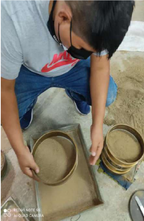
Retención en la malla N°60 de la muestra de suelo - Análisis Granulométrico
