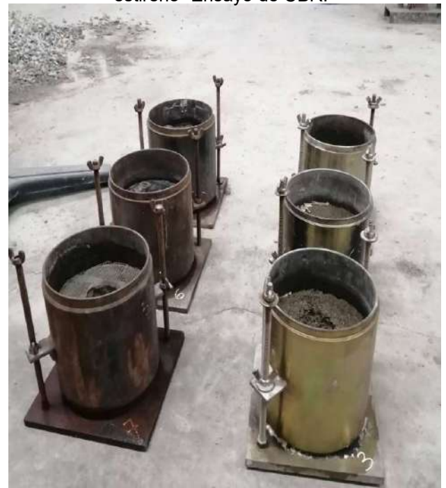
Se terminó de realizar los ensayos para obtener los resultados en gabinete (Muestra de suelo natural y suelo con polímero acrílico de estireno)- Ensayo de CBR.
