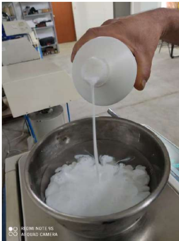
Preparando la dosificación para verterlo sobre la muestra de los 6 kg- Ensayo de CBR.
