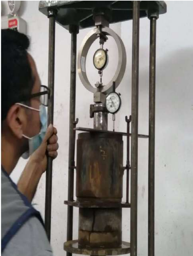
Muestra del suelo sometida a la compresión del terreno natural- Ensayo de CBR.
