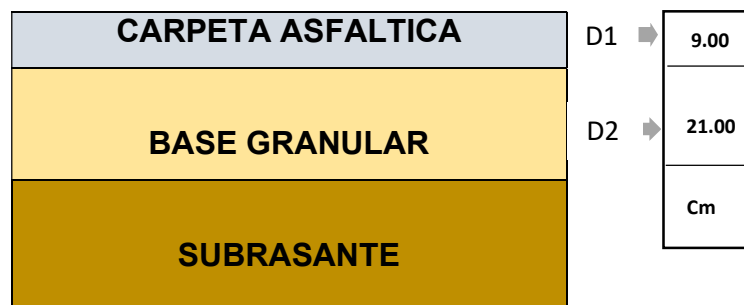
Figura 26. Diseño del pavimento flexible en estado natural.
