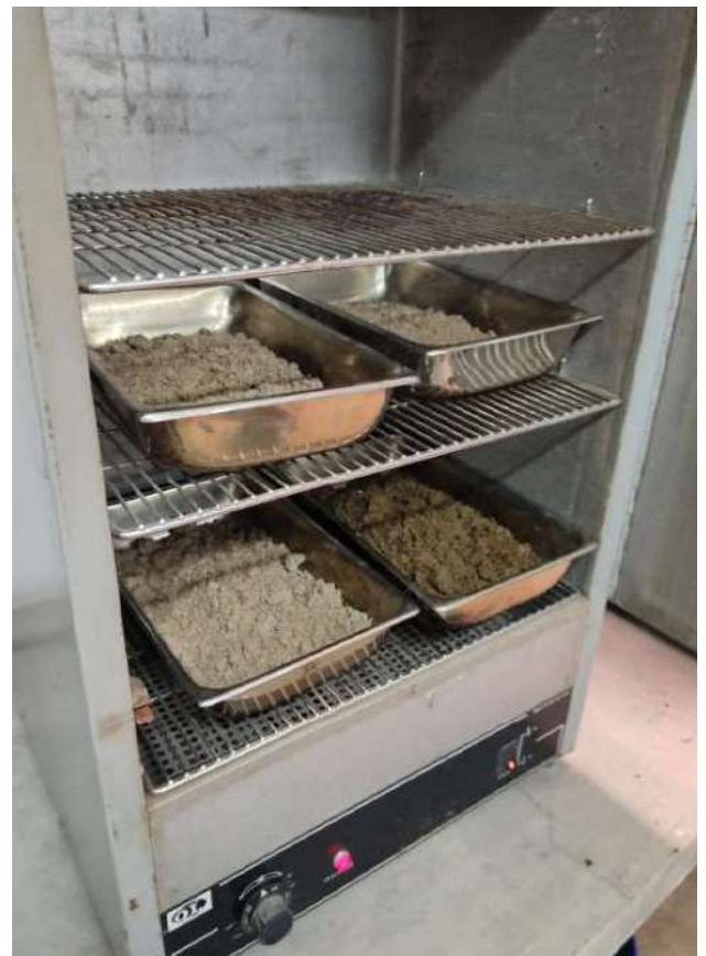
Secado de las 4 muestras de suelo en el horno, con las diferentes cantidades de agua-Ensayo PROCTOR
