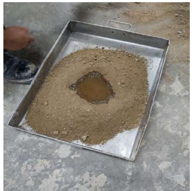
Se vierte sobre los 6kg de la muestra de suelo pesada y se homogeniza para realizar el cuarteo-Ensayo PROCTOR
