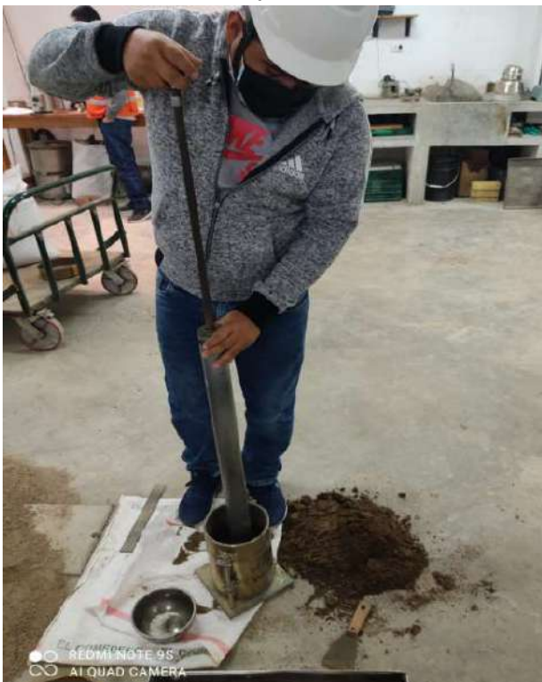
Apisonando la primera capa de 56 golpes hasta la capa 5-Ensayo PROCTOR.
