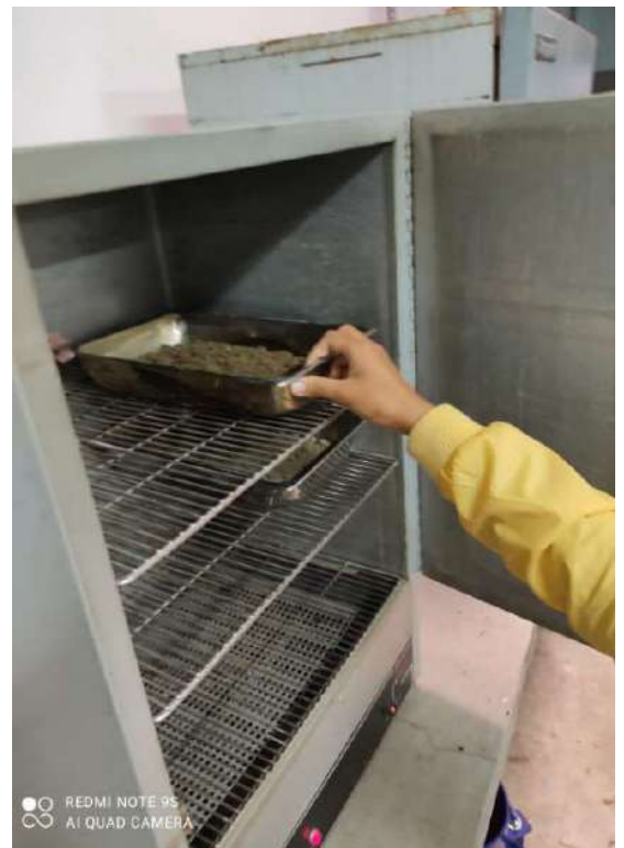
Secado de la muestra en el horno- Ensayo PROCTOR
