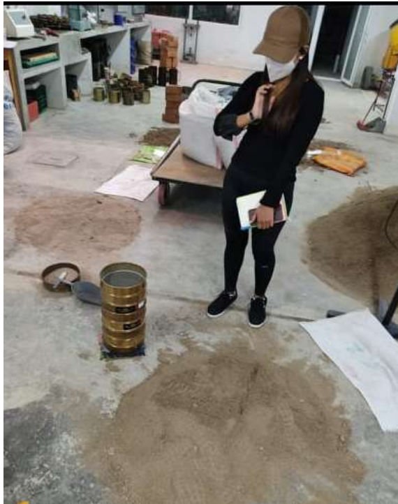
Muestra de suelo para el análisis Granulométrico - Análisis Granulométrico
