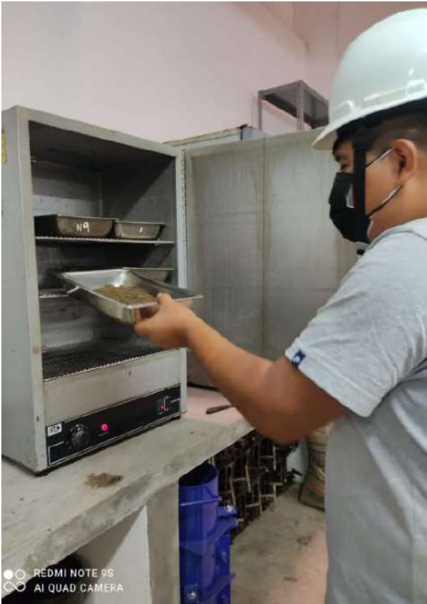
Secado de las muestras de suelo en el horno, con las diferentes cantidades de agua-Ensayo PROCTOR
