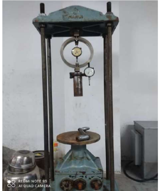
Después del 3 día de haber estado sumergido se saca de la poza los moldes y nuevamente se toma la lectura midiendo la expansión de los 3 moldes y anotando la penetración, se utilizó la máquina de 3 toneladas para tomar la lectura del Dial - Ensayo de CBR.
