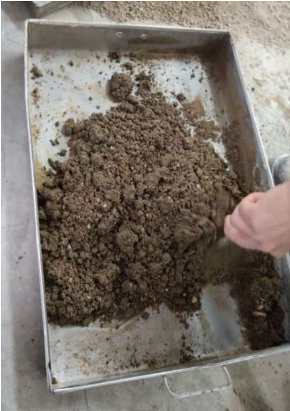
Muestra de los 6 kg homogenizada- Ensayo de CBR.
