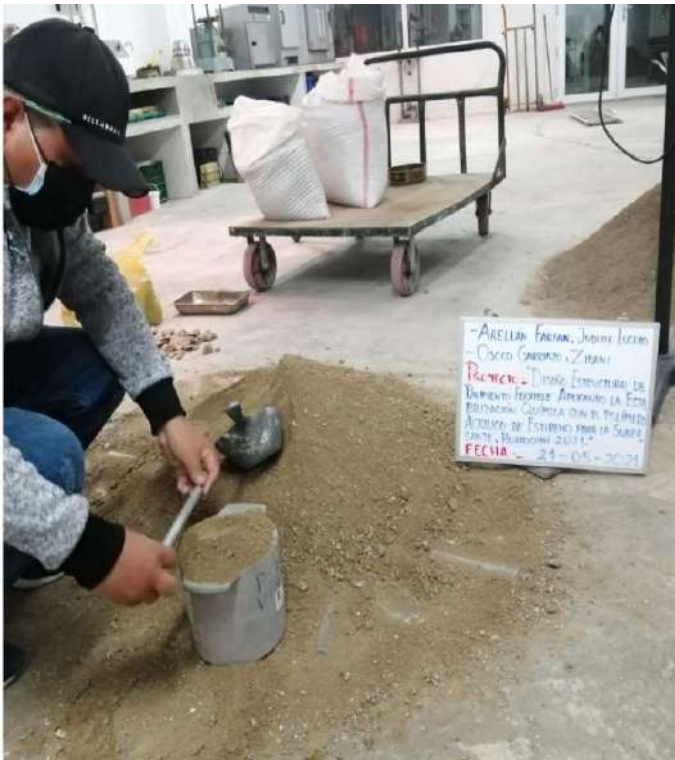
Rasando la última capa de la muestra de suelo -Ensayo PROCTOR
