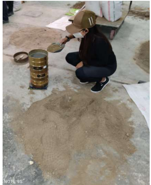
Vertiendo la muestra de suelo para el tamizado - Análisis Granulométrico
