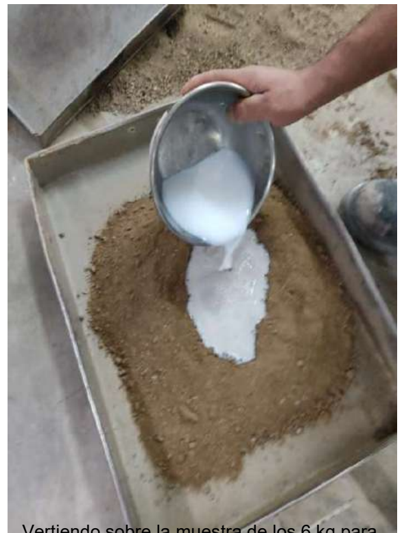
Vertiendo sobre la muestra de los 6 kg para homogenizar- Ensayo de CBR.
