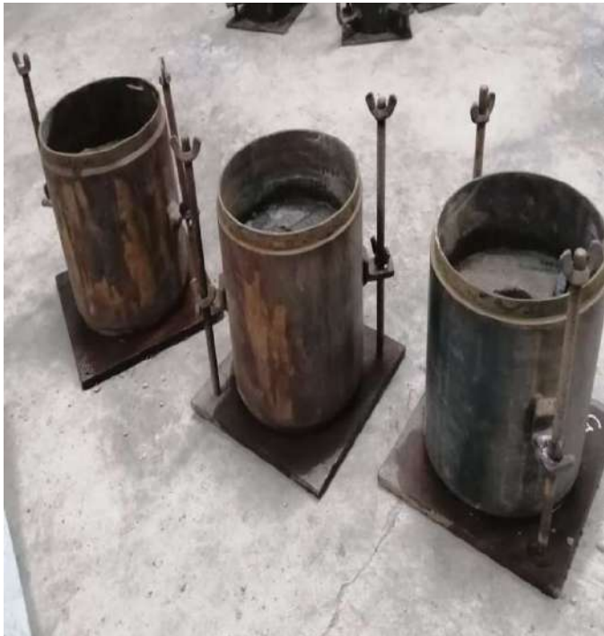
Se terminó de realizar los ensayos para obtener los resultados en gabinete (Muestra de suelo natural)- Ensayo de CBR.
