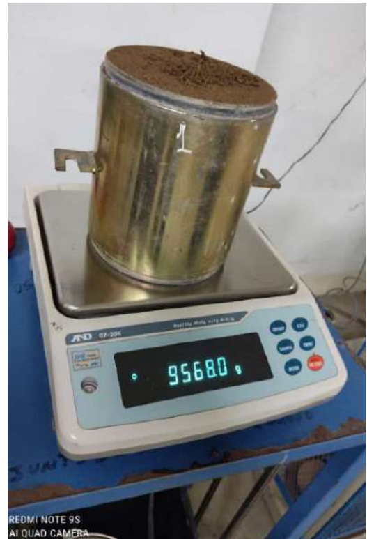
Peso total de las 5 capas compactadas con 56 golpes por cada capa - Ensayo PROCTOR
