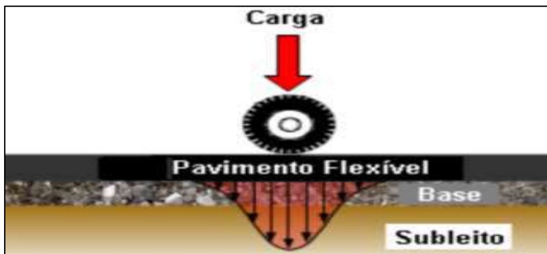
Figura 7. Representación de las cargas de pavimento flexible.
