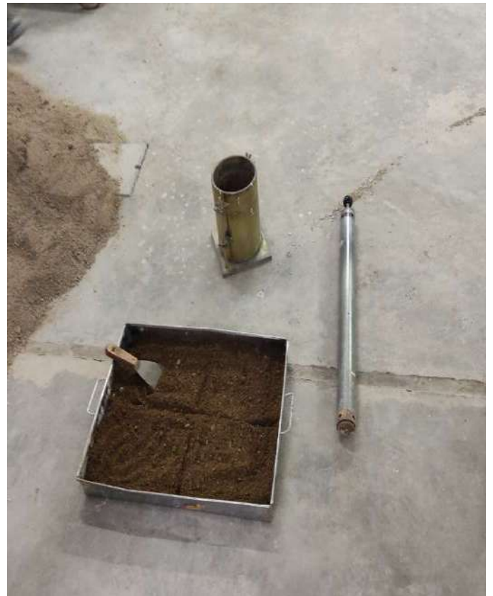
Cuarteo de la muestra, molde y el apisonador de suelo-Ensayo PROCTOR.
