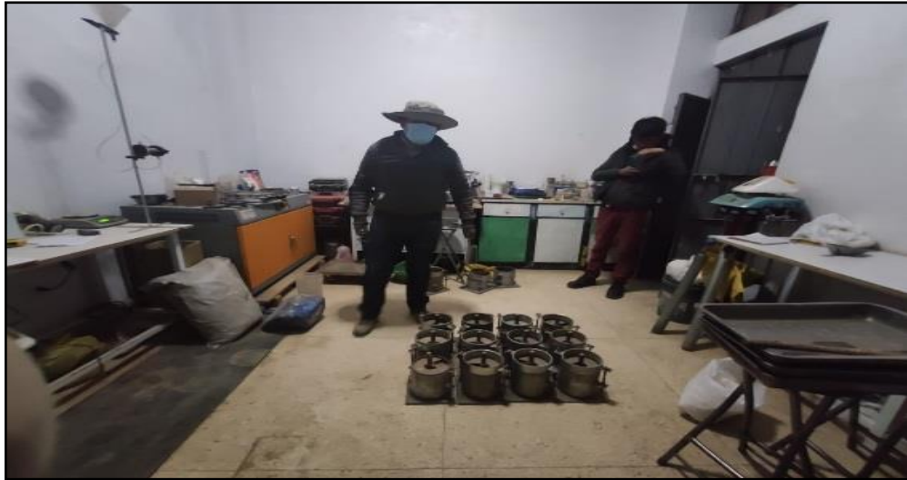
Figura 26. Briquetas del ensayo de CBR
