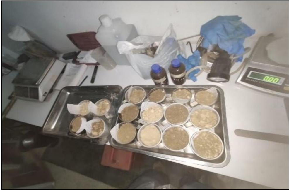
Figura 51. Pesado de muestra en la tara para el contenido de humedad.
