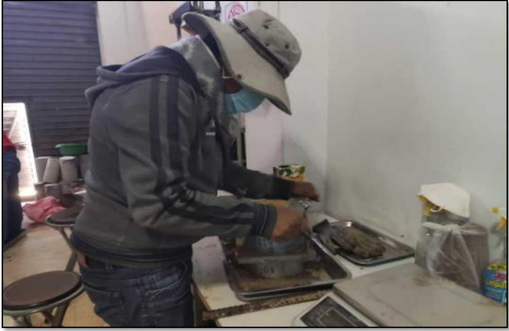
Figura 60. Enrase con regla metálica.
