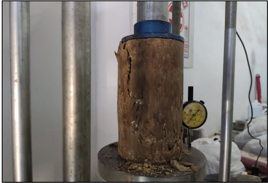
Figura 35. Se observa la falla de la briqueta.
