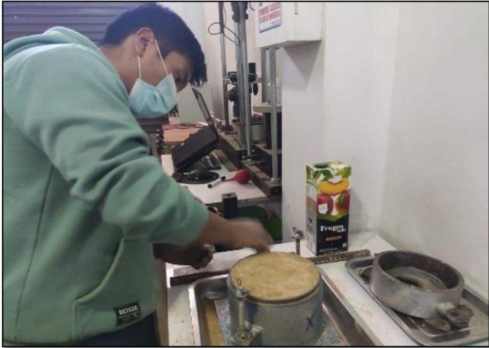
Figura 24. Enrazado de la briqueta de Proctor modificado.
