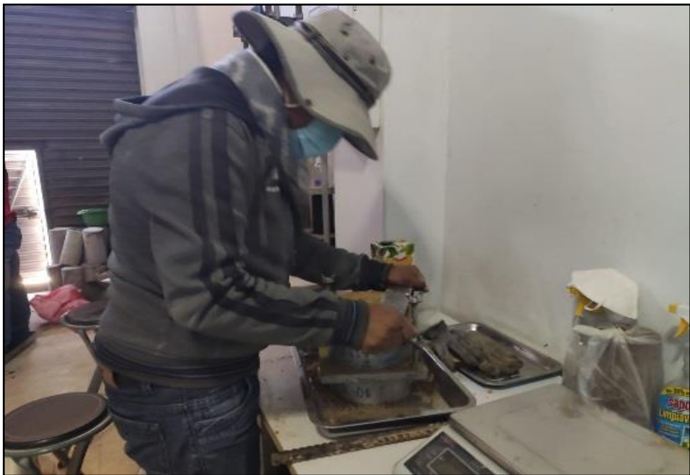
Figura 25. Enrazado de la briqueta de Proctor modificado.
