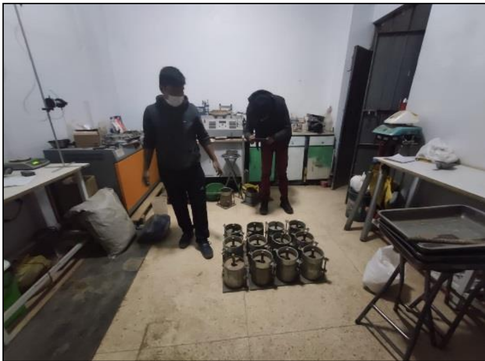
Figura 27. Briquetas del ensayo de CBR
