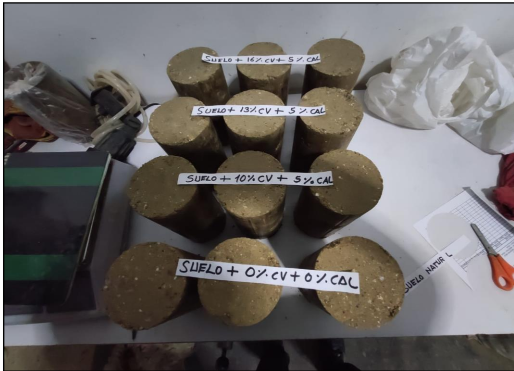
Figura 28. Briquetas del ensayo de corte no confinada
