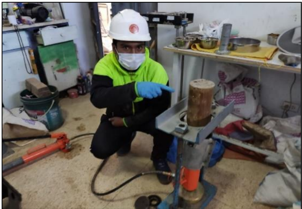
Figura 32. Extracción de la muestra.
