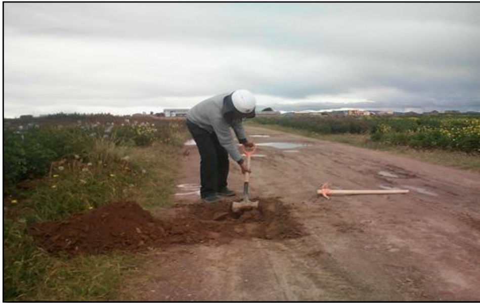
Figura 13. Extracción de material calicata N° 3
