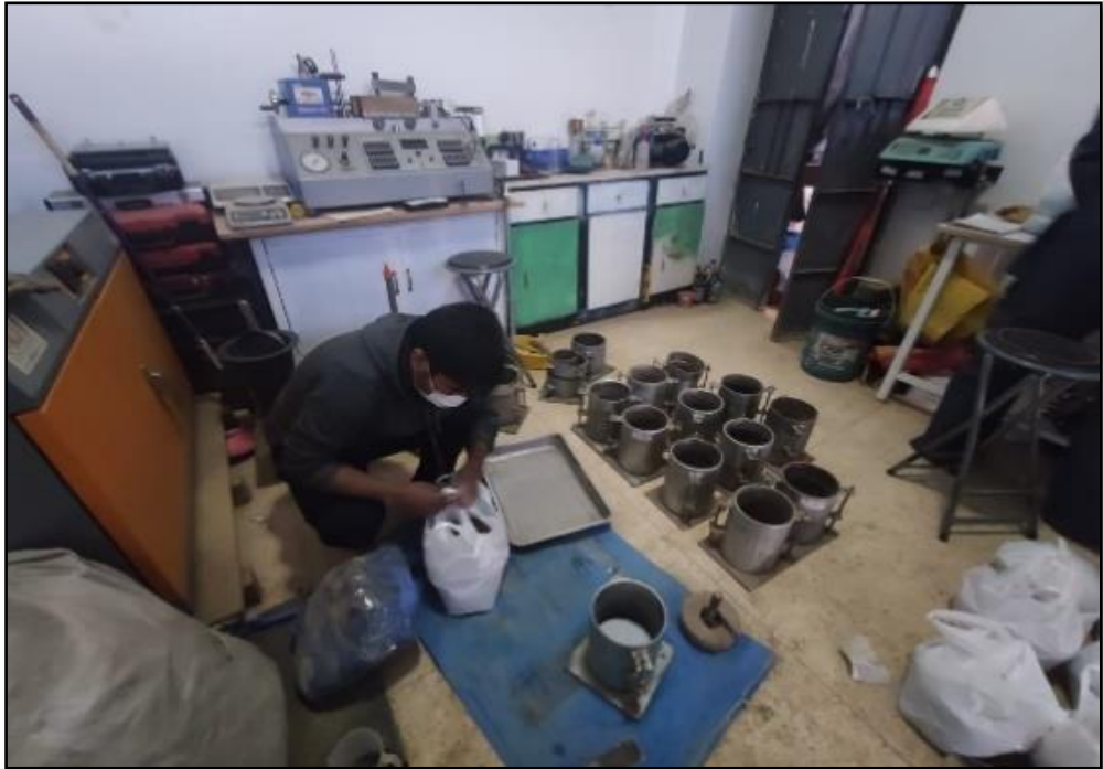
Figura 58. Colocado de papel filtro en base.
