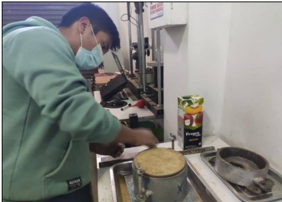
Figura 50. Enrase de molde parte superior.
