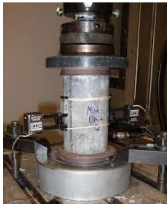
Figura 5: Ensayo de resistencia mecánica del concreto
