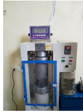
Figura 2: Rotura de briquetas de concreto.
