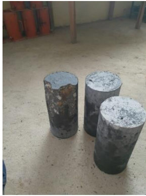
Figura 1: Muestras de briquetas de concreto
