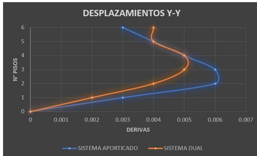
Figura 64. Desplazamiento relativo en dirección Y-Y.
