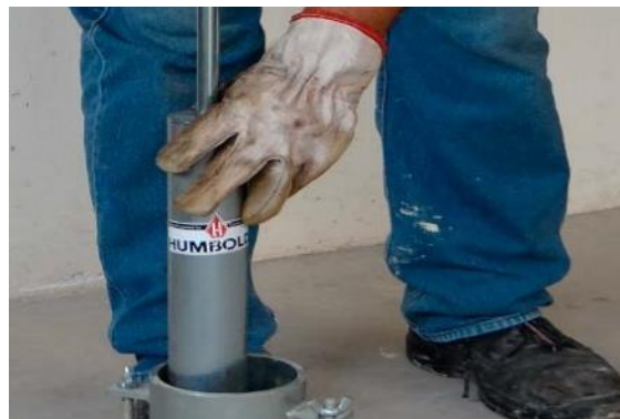
Figura 16. Ensayo Proctor Modificado
