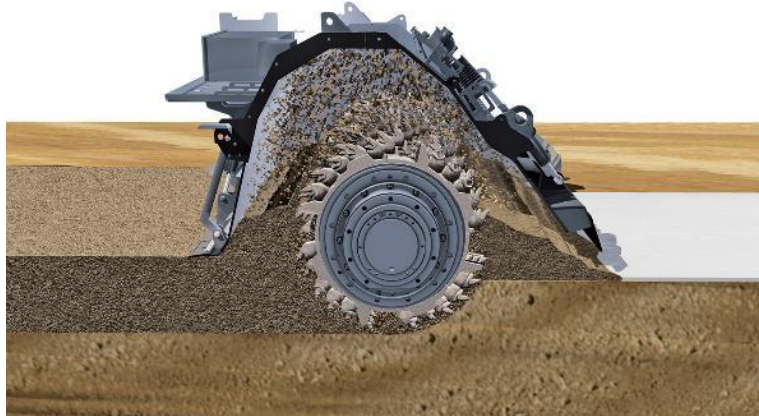
Figura 11. Proceso de estabilización por reciclado
