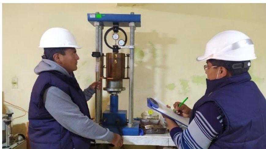
Figura 52. Elaboración del ensayo CBR
