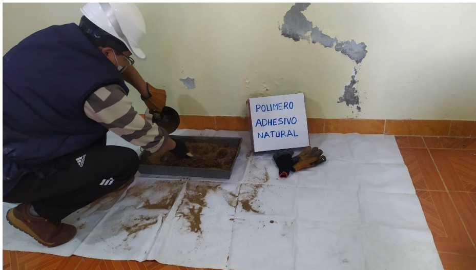
Figura 31. Proceso de mezclado del suelo con el polímero adhesivo natural
